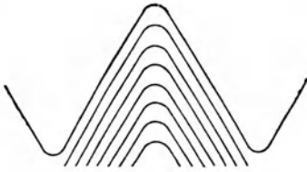
Abb. 186. Zustellung des Gewindestahles senkrecht zur Drehachse.
