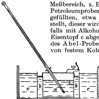
Abb. 41. Abelscher Petroleumprober, Anordnung zur Bestimmung sehr tiefer Flammpunkte.
