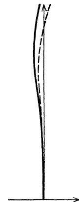
Fig. 4. Kurven der sagittalen u. tangentialen Bildfeldwölbungen. — sagittale Bildfeldwölbungskurve. --- tangentialen Bildfeldwölbungskurve.
