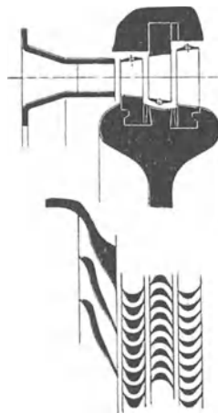
Teile der Dampfturbine.
