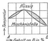
Fig. 5. Typus 4. Zustandsdiagramm einer lückenlosen Reihe von Mischkristallen mit einem Maximum.
