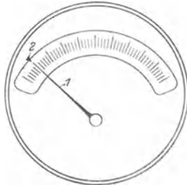
Fig. 1. Kontrollmanometer mit einer Skale und 2 konzentrischen Zeigern.
