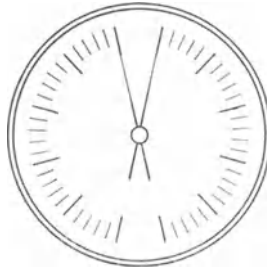
Fig. 3. Kontrollmanometer mit 2 Skalen und 2 spiegelbildlich sich bewegenden Zeigern.
