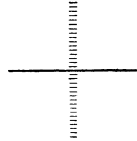
Fig. 7. Abbildung bei Einstellung der lichtempfindlichen Schicht in die Fläche der tangentialen Bildpunkte.
