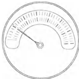
Fig. 2. Kontrollmanometer mit 2 Skalen und 2 konzentrischen Zeigern.
