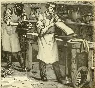
OUVRIER FABRIQUANT LA PORCELAINES. — La porcelaine se fabrique avec une terre très fine, le kaolin, qu'on réduit en pâte. Ensuite on divise cette pâte en feuilles blanches comme des feuilles de papier. L'ouvrier de droite tient une de ces feuilles entre ses mains et va l'appliquer sur le moule pour en faire un saladier. En même temps il fait tourner le moule. L'ouvrier de gauche est plus avancé en besogne. Sa feuille a déjà la forme du moule et il achève de l'appliquer avec une éponge. Il n'y a plus ensuite qu'à faire cuire au four les objets fabriqués.
