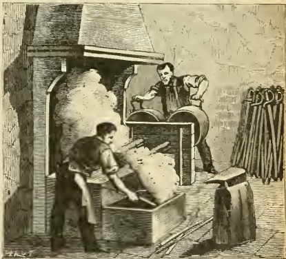
OUVRIER TREMPANT L'ACIER. — Pour donner de la dureté et de l'élasticité à l'acier (par exemple aux lames de sabres et d'épées), on le fait rougir, puis on le trempe tout à coup dans l'eau froide.
