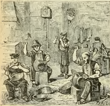
CHAUDRONNERIE D'AUILLAC. — La chaudronnerie est l'art de fabriquer tous les ustensiles en métal, comme ceux qui servent à faire chauffer l'eau et les aliments. La petite chaudronnerie fabrique les chaudrons de cuisine, les casseroles, les poêlons, etc. La grosse chaudronnerie fabrique les énormes chaudières des locomotives ou des bateaux à vapeur, les cuves des teinturiers, etc. L'Auvergne et la Normandie sont les centres de la chaudronnerie.
