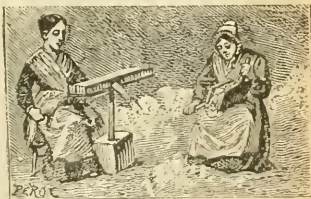
OUVRIÈRES DE REIMS CARDANT ET PEIGNANT LA LAINE. — La laine, comme le coton, a besoin d'être débarrassée de tous les filaments étrangers et de toutes les impuretés. Pour cela on la carde. Ce mot vient d'une espèce de chardon à tête épineuse, la cardère , dont on se sert pour brosser la laine. Ensuite on la peigne comme nous peignons nos cheveux.
