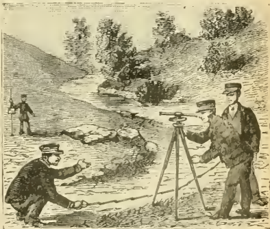
INGÉNIEURS DES PONTS ET CHAUSSEES LIVANT UN PLAN. — L'ingénieur placé à droite mesure l'élevation du terrain à l'aide d'un instrument appelé niveau . Pour cela il regarde à travers cet instrument la mitre que tient l'homme placé dans le fond. Celui qui est penché vers la terre mesure la superficie du terrain à l'aide d'une longue chaîne dite chaîne d'arpenteur .
