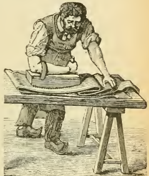
MÉGISSIER TRAVAILLANT À ASSOULPIR UNE PEAU. — Lorsque le cuir a été tanné et qu'il a subi les premières préparations, il reste à le rendre doux et souple. Pour cela, l'ouvrier l'étend sur une table et le frotte avec un instrument en bois cannelé qu'on nomme marquerite . — On appelle mégissiers les ouvriers qui travaillent les peaux fines, et corroyeurs ceux qui travaillent les peaux plus grossières.
