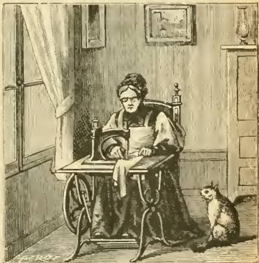
LA MACHINE À COUDRE. — Cette machine, si utile et si répandue aujourd'hui, a été inventée il n'y a pas longtemps par l'Américain Elias Howe. On la met la plupart du temps avec le pied. Elle coud avec rapidité et solidité. Une machine à coudre peut faire l'ouvrage de deux ouvrières actives.
