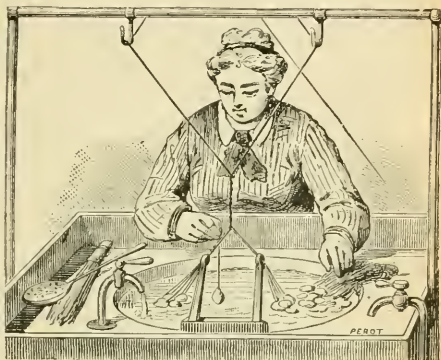
OUVRIÈRE DU DAUPHINÉ FILANT LA SOIE DES COCONS. — A mesure que les fils de soie se déroulent des cocons, ils s'enfilent par deux trous que l'on voit à droite et à gauche, puis ils passent sur deux crochets au-dessus de la tête de la dévideuse, et de là vont s'enrouler sur un dévidoir qu'on ne voit pas dans la gravure. Ce dévidoir est mis en mouvement par les pieds de la fileuse ou par l'aide d'une autre personne.
