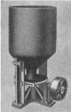
Abb. 82. Aufgabegerät mit Austragteller für feste Reagenzien.
