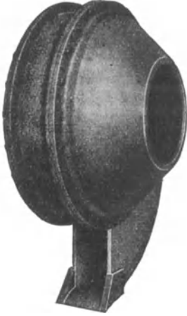
Abb. 72. Schöpfaufgabe für Kugelmühlen mit Rüssel und offenem zentralen Einlauf für zweierlei Gut.
