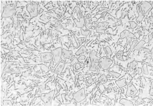
Abb. 21. Schlibbild einer Alusil-Kolbenlegierung.
