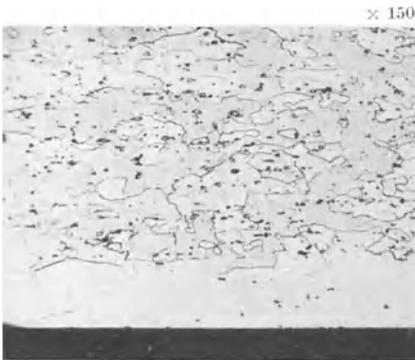
Abb. 10. Übergang der Plattierschicht in den Kernwerkstoff.
