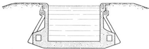
Fig. 25. Querschnitt der fertigen Schleuse des Inner Navigation Canal.
