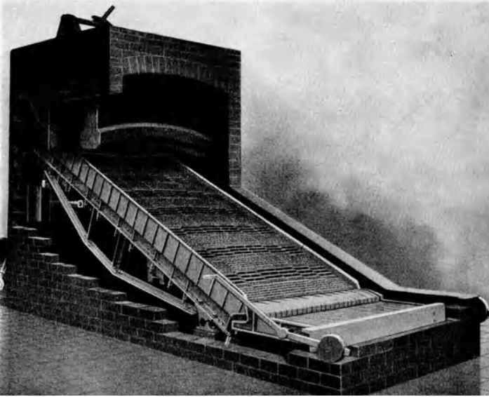
Abb. 58b. Ansicht eines vollmechanischen Vorschubtreppenrostes mit Zündwehr von Babcock.
