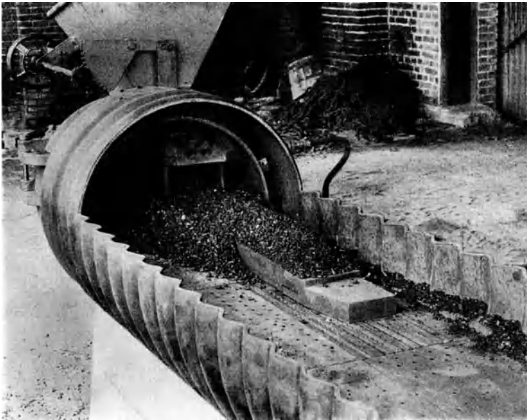
Abb. 63a u. b. Planstoker (Doby) der Vereinigten Kesselwerke A.G. A Hauptrost, B Ausbrandrost, C Vorschubkolben, D Kohlenrichter, E Elektromotor mit Schneckengetriebe, F Wechselgetriebe, G Oberwind (Zweitluft), H Unterwind, I Feuertür, K Aschentür, L Schauloch.
