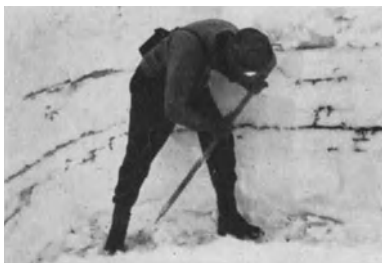
Abb. 28. Färbversuch: Mehrere wasserführende Lagen (Harschtschichten) sind durch Anilinfärbung sichtbar gemacht. Vom obersten Wasserhorizont saugt sich das Schmelzwasser kapillar in die aufgelagerte Neuschneesicht empor (links oben). (Photo: Paulcke.)
