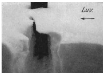
Abb. 88. Experiment zur Klärung der Bildung der Schneebrücken über Spalten. Der Wind kam von rechts. (Photo: Paulcke. Zeitraffer-Laufbild.)
