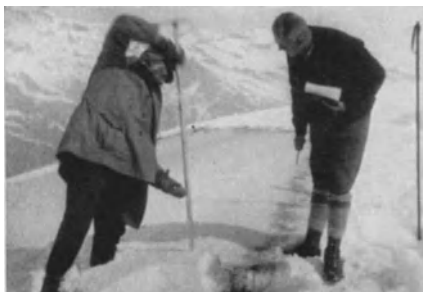
Abb. 133. Bohrung mit Paulckes Schneeborher zur Feststellung von „Schneeprofilen“ und der Sickergeschwindigkeit des gefärbten Schmelzwassers in der Tiefe, am leicht nach links geneigten Hang. (Photo: Paulcke.)
