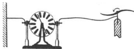
Abb. 90. Flugrad. — Lehrreiche Abart: Man hängt einen leichten, aus einer Spitze und einem Ring starr zusammengesetzten Kondensator an zwei dünnen Zuleitungen auf; dies „Pendel“ schlägt aus, sobald der Strahl des elektrischen Windes durch den Ring hindurchbläst.
