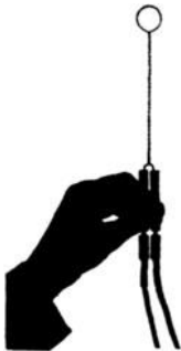
Abb. 183. Probenspule zur Messung der Kraftflußdichte eines Elektromagneten. Eine Windung von 3 \text{ cm}^2 Fläche, also Windungsfläche nF = 3 \cdot 10^{-4} \text{ m}^2 .
