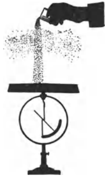
Abb. 423. Trennung von Elektrizitätsträgern durch verschiedene Fallgeschwindigkeit (feines Bleischrot und Schwefelstaub). Ein seitlicher oder aufwärts gerichteter Luftstrom verbessert die Trennung erheblich.
