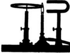
Abb. 221. Ein einseitig erhitztes Nickelrad rotiert im Felde eines Magneten. Bei 356 Grad C. verliert Nickel seinen Ferromagnetismus, und dann zieht der Magnet ein kälteres, noch ferromagnetisches Stück des Rades heran. Die Mittelebene des Magneten geht durch die Radachse. Die Flamme wird je nach dem gewünschten Drehsinn etwas vor oder hinter diese Mittelebene gestellt.
