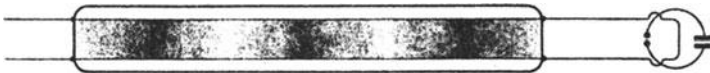
Abb. 468. Sichtbarmachung der Feldverteilung stehender elektrischer Drahtwellen. Zum Abtasten des Feldes zwischen Drahtleitungen in freier Luft eignen sich gut kleine Glimmlämpchen.
