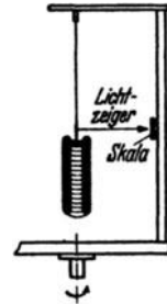
Abb. 496. Versuch von Trouton und Noble, um eine Abhängigkeit der Kondensatorenergie von der Orientierung festzustellen. Schematisch.
