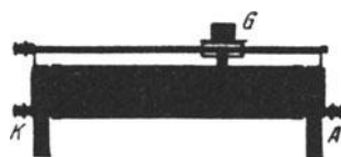
Abb. 34. Technische Ausführung eines Widerstandes mit Gleitkontakt G . Der Draht ist auf einen isolierenden Zylinder aufgespult.
