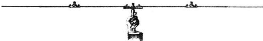
Abb. 462. Dipol mit drei Glühlampen zur Vorführung der Verteilung des Leitungsstromes in ihm.
