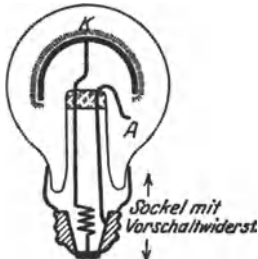
Abb. 337. Glimmlampe. Neon-Helium-Gemisch. Druck ca. 15 mm Hg-Säule.
