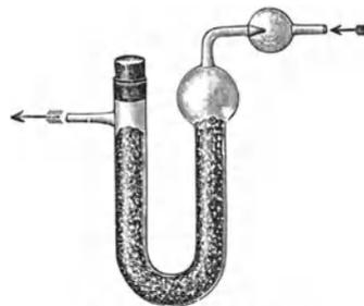
Abb. 57. Chlorkalziumrohr.
