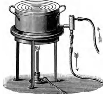
Abb. 4. Wasserbad mit konstantem Niveau.
