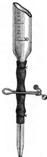
Abb. 96. Verschluss einer Bürette mittels eines Quetschhahnes.
