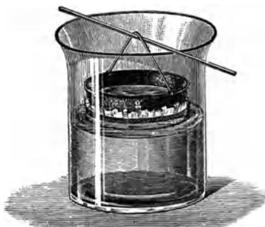
Abb. 39. Vorrichtung zum Dialysieren.
