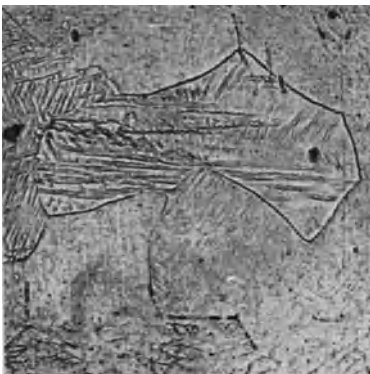
Abb. 119. Gußgefüge von Mg-Al6, 24 Stunden bei 400^\circ geglüht.
