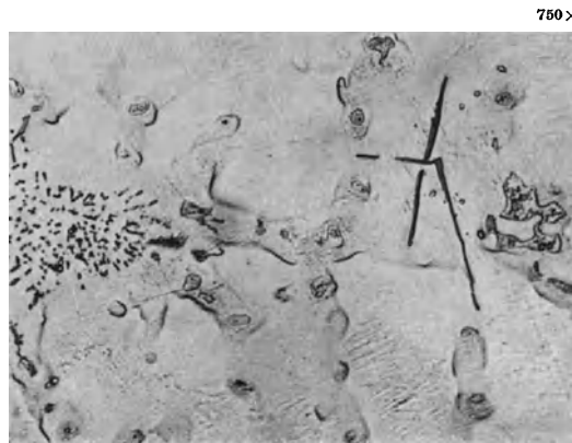
Abb. 21. Binäres und ternäres Eutektikum in einer Mg-Al-Mn-Legierung.
