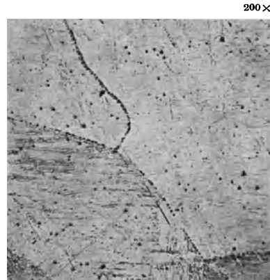
Abb. 54. Reinmagnesium mit Korngrenzenverunreinigungen, jedoch gleichem Reinheitsgrad wie Abb. 53.
