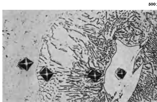
Abb. 124. Mikrohärteeindrücke an Gußgefüge von Mg-Al 6.
