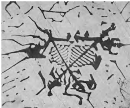
Abb. 36. Mg_2Si -Primärkristall nach dem Umschmelzen.
