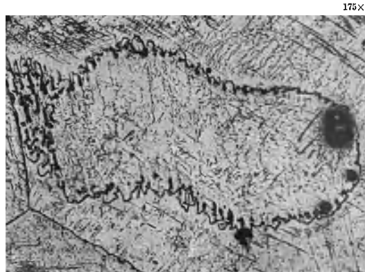
Abb. 45. Eisenanordnung im Magnesiumkristall.
