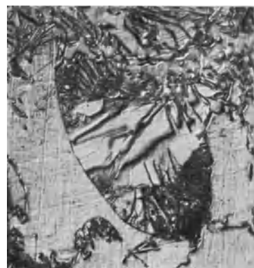
Abb. 133. „Eutektoid“ im Schräglicht, Lamellen in der Schlißfläche liegend.
