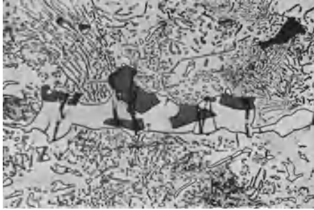
Abb. 148. Zelliges \text{Al}_2\text{Mg}_3 mit angelagerten \text{Mg}_2\text{Si} -Kristallen, beide Kristallarten im Zugversuch mehrfach gerissen.
