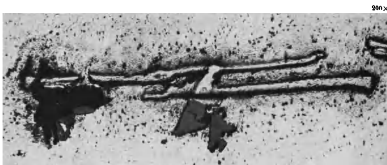
Abb. 39. Eisenkristall aus langsam erstarrter Schmelze.
