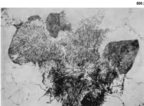
Abb. 159. „Eutektoid“-Zonen innerhalb der Körner mit glatten Grenzen wachsend.
