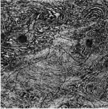
Abb. 94. Durch Strangpressen schlierenförmig verformte Basisstreifung.
