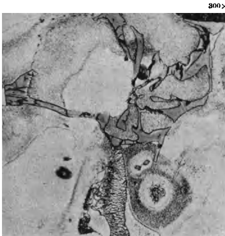
Abb. 109. Mg_3Si in Gußgefüge von Mg-Al 6.
