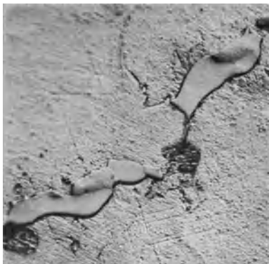
Abb. 203. Sandguß G Mg-Al6-Zn. In Al_2Mg_3 Zonen einer ternären Phase.
