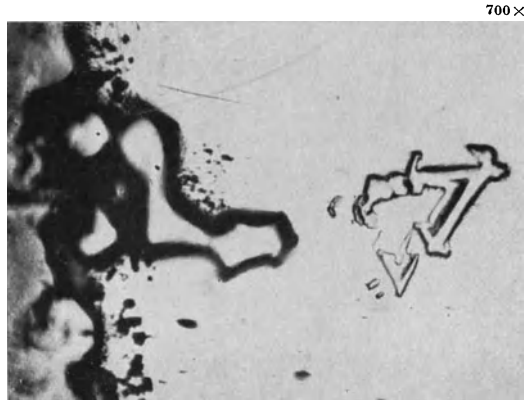
Abb. 40. Eisenkristall aus Tiegelwand gelöst und wieder ausgeschieden.
