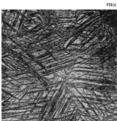
Abb. 199. Zwillinge aus Schmiedeteil, durch Anlaßbehandlung sichtbar gemacht.
