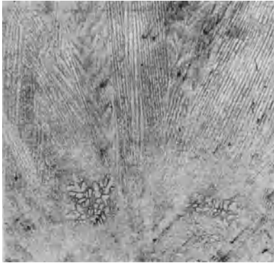
Abb. 101. Grätenartiges Erstarrungsgefüge aus schnell erstarrtem Mg-Mn-Guß.
