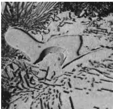
Abb. 121. \text{Al}_2\text{Mg}_3 , schräg ins Magnesium verlaufend.
