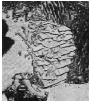
Abb. 158. Übersättigte Zonen mit starken Korngrenzausscheidungen.
