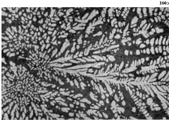
Abb. 22. Mg-Al-Versuchslegierung. Dendriten aus \text{Al}_2\text{Mg}_3 .
