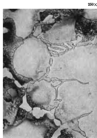
Abb. 110. Zinkhaltige Al_2Mg_3 -Phase neben Al_4Mg_3 im Gußgefüge von Mg-Al 3.
