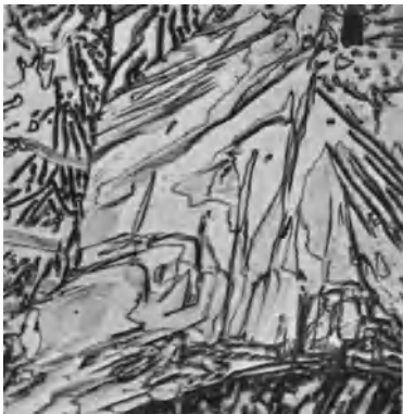
Abb. 132. Al_2Mg_3 -Lamellen von „Eutektoid“, sehr flach in der Schlißfläche liegend.
