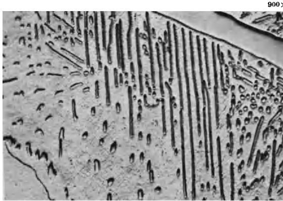
Abb. 25. \text{Al}_2\text{Mg}_3 und „eutektoid“ Zone, diese links unten nochmals gegen den Mg-Mischkristall deutlich abgesetzt.
