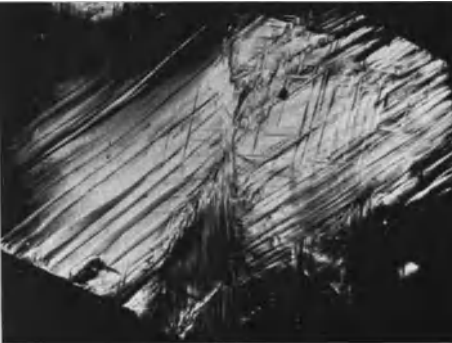
Abb. 14. Verformte Basisfläche eines Magnesium-Einkristalles mit Translation und Zwillingsbildung.
