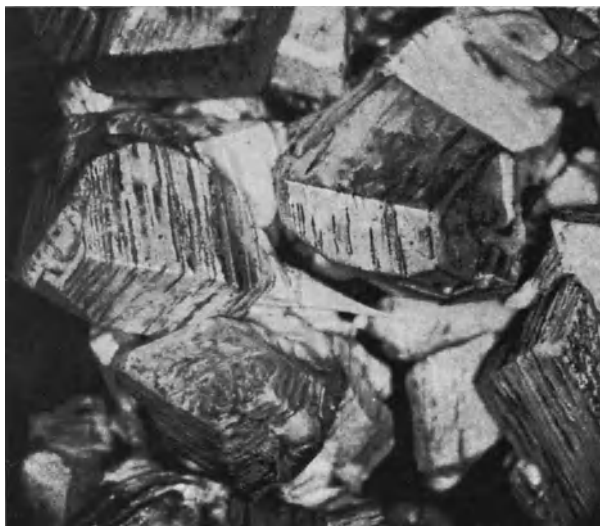
Abb. 105. Ätzung auf Pyramiden- und Prismenflächen von Magnesiumkristallen parallel zur Basis.
