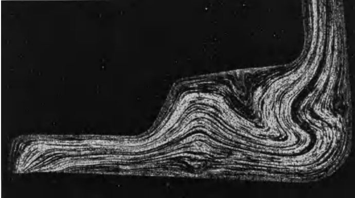
Abb. 217. Grobätzung an einem Schmiedeteil aus Mg-Al6 mit fehlerhaftem Faserverlauf.
