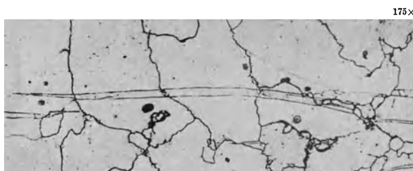
Abb. 198. Zwilling in der Legierung Mg-Al6, durch mehrere Körner gehend.
