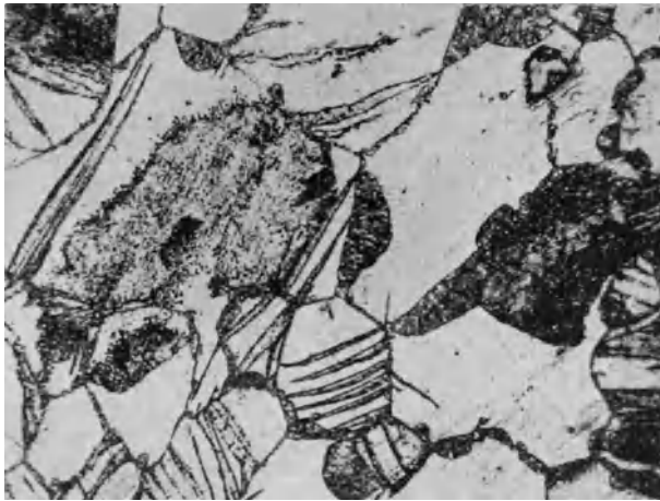
Abb. 176. Zwillinge, in der Schliffebene liegend und „Eutektoid“.
