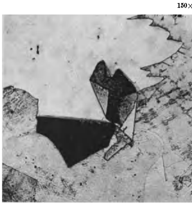
Abb. 63. Losgelöste und umgeklappte Ätzhaut.
