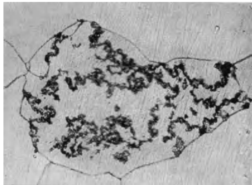
Abb. 62. Oberflächenkorrosion an einem mit der Basis in der Schlißfläche liegenden Korn.
