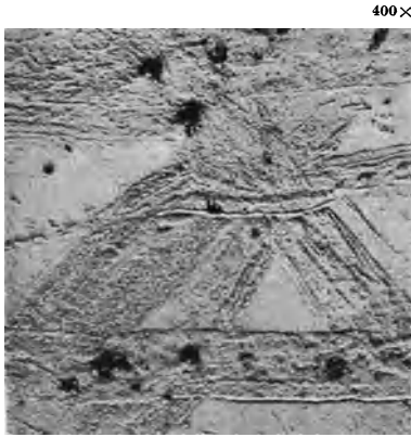
Abb. 84. Zwillingsbildung in Mg-Mn-Guß durch nachträgliches Quetschen erzeugt.
