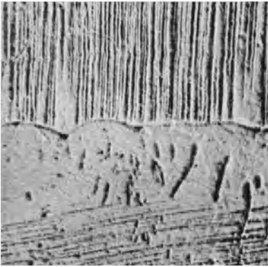
Abb. 68. Steil angeschliffene lamellenförmige Ausscheidungen von Mangan.
