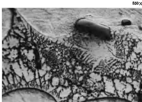
Abb. 47. Ternäres Eutektikum, vielleicht mit Eisen.
