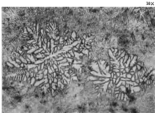
Abb. 7. Primärdendriten von Magnesium, aus einer binären Mg-Mn-Legierung mit 2% Mn.
