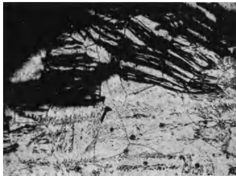
Abb. 104. Bevorzugte Korrosion längs der Basis bei Reinelementmagnesium.
