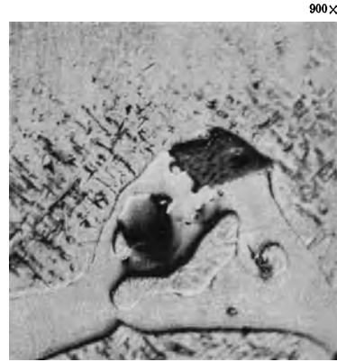
Abb. 123. \text{Al}, \text{Mn}, \text{Al}_2\text{Mg}_3 und \text{Mg}_3\text{Si} im Magnesiummischkristall.
