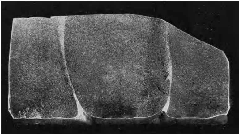
Abb. 222. Umgekehrte Blockseigerung vom Rand eines Kokillengußbolzens aus Mg-Al 6.
