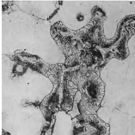
Abb. 127. Gußgefüge von Mg-Al 6 mit starker „Eutektoid“-Ausbildung.
