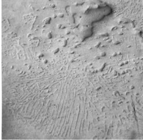
Abb. 126. Guß von Mg-Al6, auf Gummi reliefpoliert, ungeätzt.
