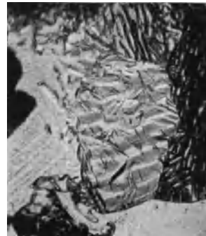
Abb. 160. „Eutektoid“ aus einer Preßstange, im normalen und im Schräglicht mit um 180^\circ wechselnder Einfallsrichtung.
