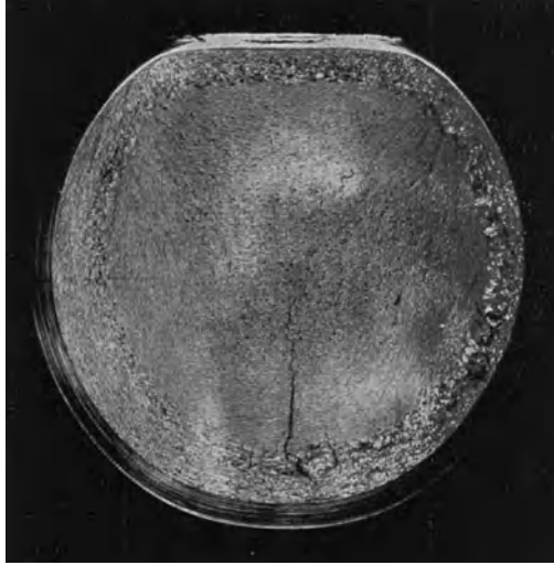
Abb. 225. Bruchgefüge einer 70 mm starken Rundstange aus Mg-Al6, nach dem Richten gegläht. Grobkornbildung (Bearbeitungsrekristallisation) durch Verformung beim Richten.
