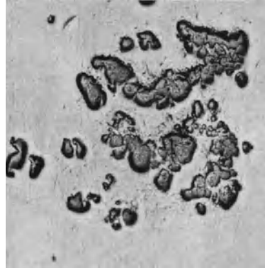
Abb. 15. Primärkristalle von Mangan.
