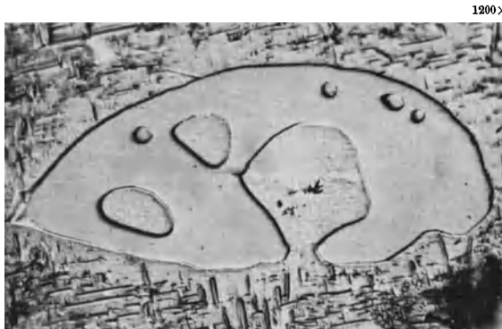
Abb. 24. Entartetes binäres Eutektikum aus Mg-Mischkristall und \text{Al}_2\text{Mg}_3 . Schräglicht.
