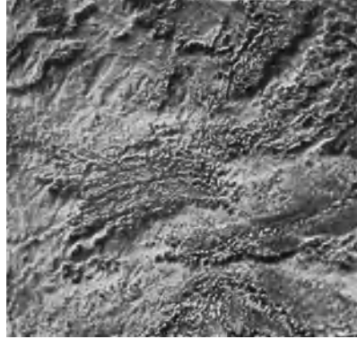
Abb. 67. Flach angeschliffene lamellenförmige Ausscheidungen von Mangan.
