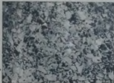
Рис. 204. Бортовой вал парохода „Алтай“: \sigma_p = 23,6 кг/мм 2 ; \sigma_b = 48,8 кг/мм 2 ; i = 28,9\% ; \psi = 51,6\% ; a = 2,95 кгм/см 2 .
