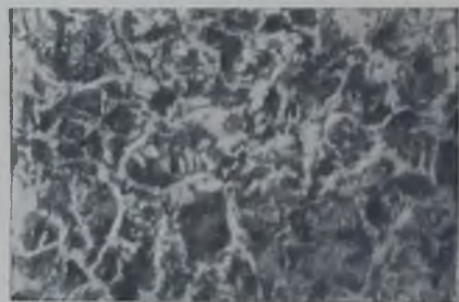
Рис. 258. Головные болты машины парохода „Краснознаменец“: \sigma_p = 35,8 \text{ кг/мм}^2 ; \sigma_b = 75,1 \text{ кг/мм}^2 ; i = 10,7\% ; \phi = 23,0\% ; a = 2,46 \text{ кг/см}^2 .
