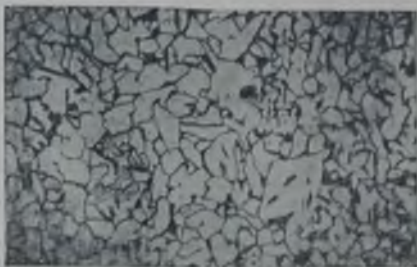
Рис. 419. Левая жаровая труба котла парохода „Дюруха“: \sigma_p = 16,9 \text{ кг/мм}^2 ; \sigma_b = 37,8 \text{ кг/мм}^2 ; i = 36,7\% ; \psi = 71,4\% ; a = 18,8 \text{ кгм/см}^2 .
