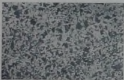
Рис. 215. Гребной вал парохода „Воровский“: \sigma_p = 27,5 кг/мм 2 ; \sigma_b = 57,6 кг/мм 2 ; i = 25,3\% ; \psi = 51,0\% ; a = 4,9 кгм/см 2 .
