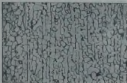
Рис. 413. Правая огневая камера котла парохода „Цюрупа“: \sigma_p = 18,9 кг/мм 2 ; \sigma_b = 36,0 кг/мм 2 ; i = 35,0\% ; \psi = 71,5\% ; a = 19,27 кгм/см 2 .
