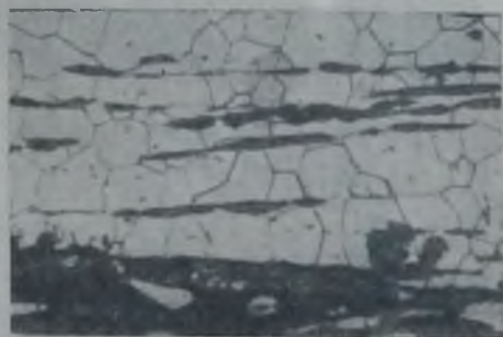
Рис. 401. Бочка котла № 2 Семипалатинского судоремонтного завода: \sigma_p = 15,5 кг/мм 2 ; \sigma_b = 31,7 кг/мм 2 ; i = 28,8\% ; \psi = 73,0\% ; a = 18,3 кг/см 2 .
