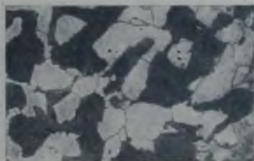
Рис. 206. Вал парохода „Труд“: \sigma_p = 23,4 кг/мм 2 ; \sigma_b = 52,9 кг/мм 2 ; i = 22,3\% ; \psi = 49,4\% ; a = 4,41 кгм/см 2 .
