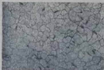
Рис. 195. Средний вал парохода „Крестьянин“: \sigma_p = 22,3 кг/мм 2 ; \sigma_b = 36,7 кг/мм 2 ; i = 17,6\% ; \psi = 63,6\% ; a = 3,07 кгм/см 2 .
