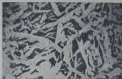
Рис. 256. Поломанный головной болт ц. н. д. машины парохода „Крым“: \sigma_p = 25,6 \text{ кг/мм}^2 ; \sigma_b = 48,1 \text{ кг/мм}^2 ; i = 29,3\% ; \phi = 60,6\% ; a = 15,2 \text{ кг/см}^2 .
