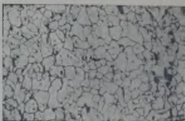
Рис. 208. Гребной вал парохода „Беспошадный“: \sigma_p = 26,7 кг/мм 2 ; \sigma_b = 54,2 кг/мм 2 ; i = 25,0\% ; \psi = 58,0\% ; a = 5,96 кгм/см 2 .
