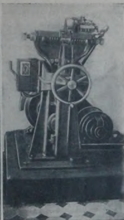
Рис. 32. Машина для определения выносливости при знакопеременном кручении.
