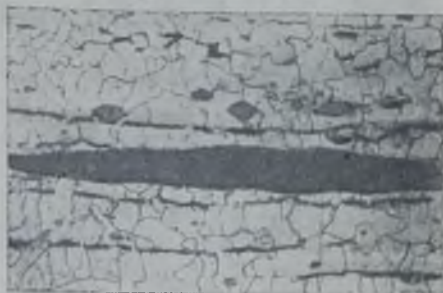
Рис. 394. Бочка котла парохода „Беднота“: \sigma_p = 15,7 \text{ кг/мм}^2 ; \sigma_b = 32,5 \text{ кг/мм}^2 ; i = 28,3\% ; \phi = 66,0\% ; a = 5,02 \text{ кг/см}^2 .
