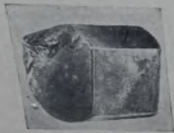
Рис. 304. Излом головного пальца ц. с. д. парохода „Лев“.
