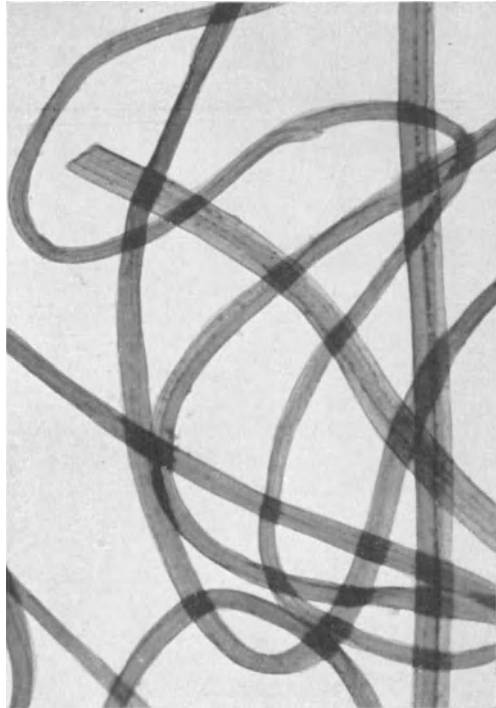
Abb. 94. Viskosestapelfaser aus einem cheviotartigen Gewebe. Vergr. 150.
