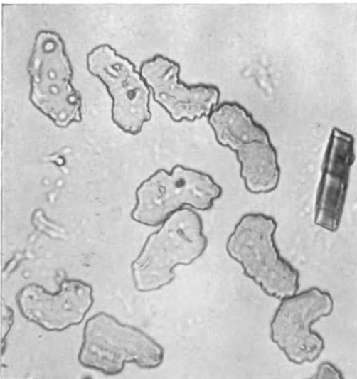
Abb. 53. Feinfädige Viskoseseide (Elberfeld 1922) im Querschnitt. Vergr. 300.
