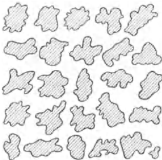
Abb. 90. Berliner Kupferstapelfaser. (Querschnitt).
