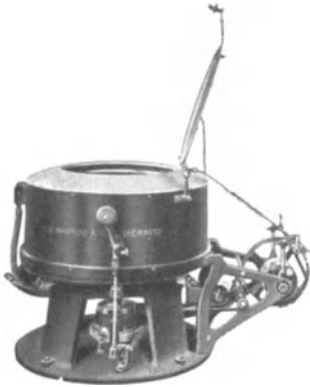
Abb. 28. Unterbetriebszentrifuge mit am Gestell angebauten Vorgelege und Sicherheits-Deckelverschluß (Haubold).
