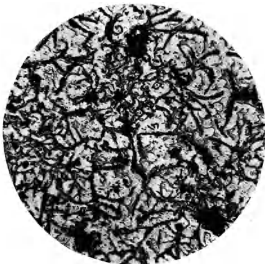
Abb. 64. Oxydation der Grauguß-Roststäbe. Beginn der Oxydation.
