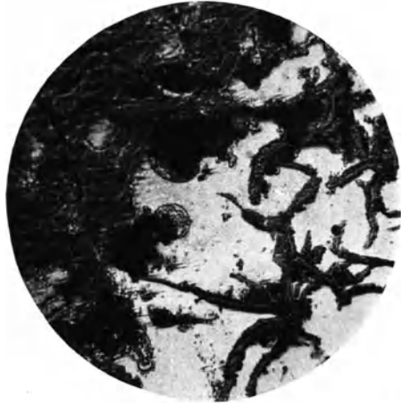
Abb. 58. Graphitische Zersetzung des Gußeisens. (Spongiose.) Übergangsstelle zwischen Metall und graphitisch zersetztem Gußeisen.
