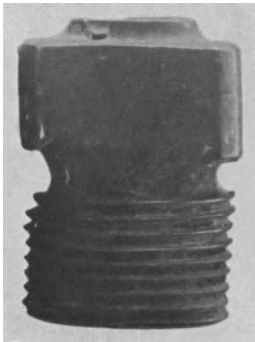
Abb. 55. Korrosion eines Schmelzpfropfens aus Rotguß. (Lokalelement.)
