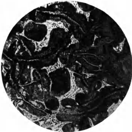
Abb. 60. Graphitische Zersetzung des Gußeisens. (Spongiose.) Gefüge der Übergangsstelle zwischen Metall und Oxydationsprodukten. (100× vergr.)
