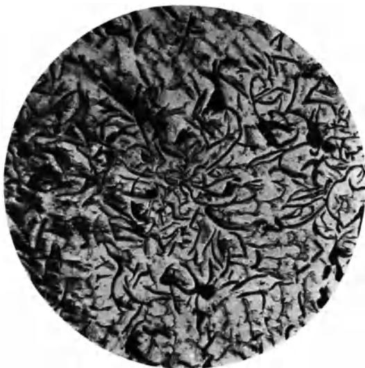
Abb. 63. Oxydation der Grauguß-Roststäbe. Verteilung des Graphits im gesunden Werkstoff längs der Graphitlamellen.
