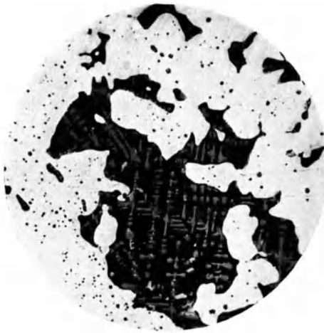
Abb. 6. Schlackeneinschlüsse in Schweißisen ( 60 \times vergr.).
