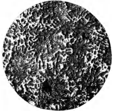
Abb. 61. Graphitische Zersetzung des Gußeisens. (Spongiose.) Netzwerk von Zementit bzw. Phosphideutektikum in oxydischer Grundmasse. (100× vergr.)
