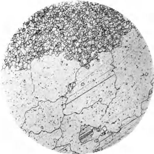
Abb. 37. Korngrößenverschiedenheit bei der Rekristallisation.
