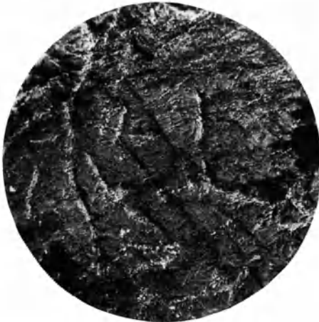
Abb. 62. Graphitische Zersetzung des Gußeisens. (Spongiose.) Gefüge der gänzlich graphitierten Zone. (100× vergr.)
