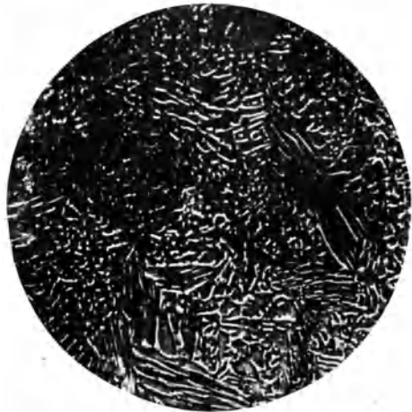
Abb. 11. Preßmuttereisen (schief beleuchtet) (120 × vergr.).
