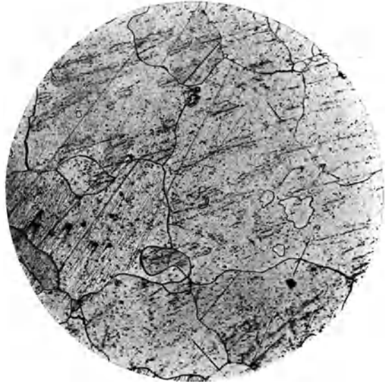
Abb. 35. Grobkornrekristallisation eines Kesselbleches.
