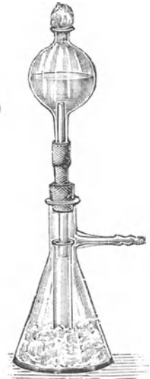
Abb. 31. Filtrierapparat nach Kitasato.
