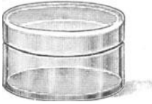
Abb. 58. Glasgefäß zur Sterilisation von Tekturen.
