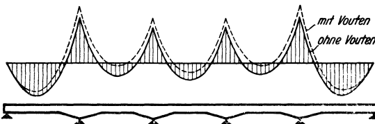
Abb.139. M-Verlauf beim Durchlaufträger mit und ohne Vouten.
