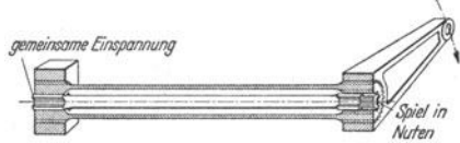
Fig. 44. Zweistufige Stab- und Rohrdrehfeder.
