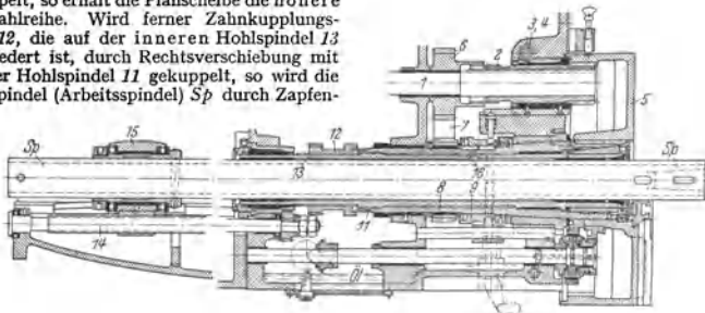
Fig. 16. Spindel- und Planscheibenantrieb zum Waagrecht-Bohr- und Fräswerk (K. Wetzel, Gera).
