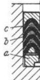
Fig. 414. Dachstulpen. a Grundring, b Stulp aus Leder oder Guttapercha, c Leder- oder Metalleinlage.
