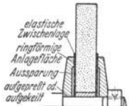
Fig. 1. Richtig eingespannte Schleifscheibe.
