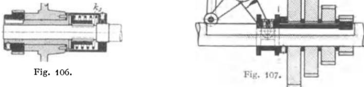
γ) **Ziehkeilkupplungen** dienen dazu, je eins von verschiedenen, lose auf der Welle laufenden Rädern mit dieser zu verbinden. Eine der einfachsten Ausführungen zeigt der Ziehkeil der Wandererwerke, Fig. 107. Allen Ziehkeilanordnungen, wie solche z. B. auch noch in den Fig. 232 und 318 dargestellt sind, haftet der Mangel an, daß eine starke Schwächung der Welle unvermeidlich ist; auf der
