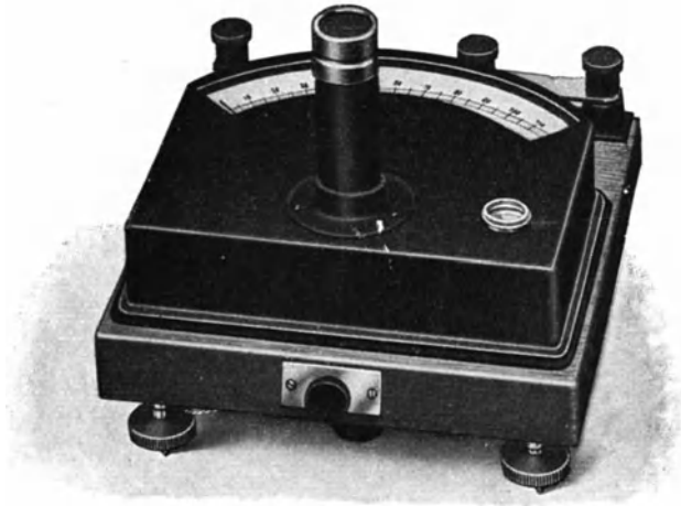
Abb. 29. Elektrodynamischer Leistungsmesser von Siemens & Halske mit Fadenaufhängung der Drehspule.
