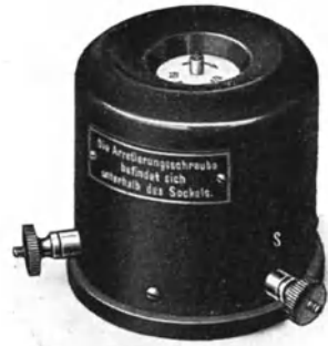
Abb. 36. Drehfeldrichtungsanzeiger von Siemens & Halske.
