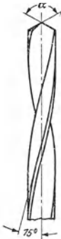
Abb. B 17. Spiralbohrer für Messing \alpha = 130^\circ , v = 35-200 m/min für SS-Bohrer; Spiralbohrer für Elektron \alpha = 116^\circ , v = 50-200 m/min für SS-Bohrer.
