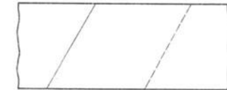
Abb. R 5. Verkitten von Balata- und Gummiriemen.
