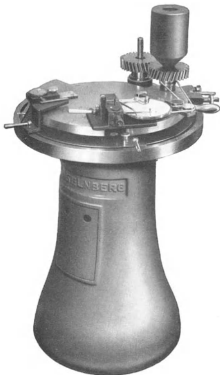
Bild 6. Universal-Zahnradprüfmaschine — nach dem Pendelsystem.
