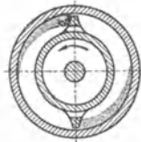
Abb. K 5. Pulvis-Anlaufkupplung 10 a) mit Füllung aus graphitiertem Stahlsand.
