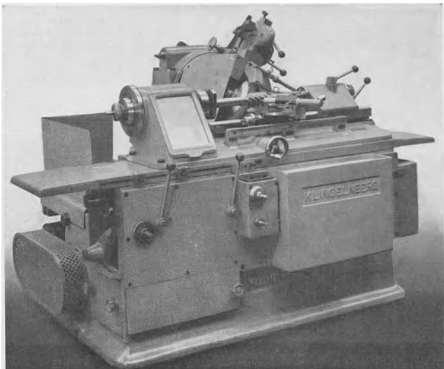
Bild 4. Selbsttätige Schneckenschleifmaschine nach dem Vergleichsschleif-Verfahren.
