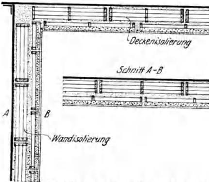
Fig. 19. Verkleidung einer Funkenkammerwand oder dergl. in Thermosbau.
