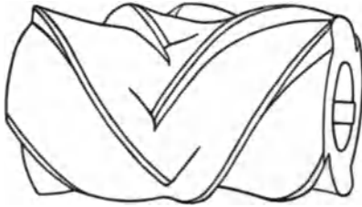
Fig. 22. Der Tenax Hochleistungsfräser.
