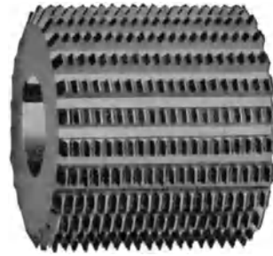
Fig. 238. Fräser für Spitzgewinde.
