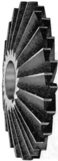
Fig. 237. Fräser für Trapezgewinde.
