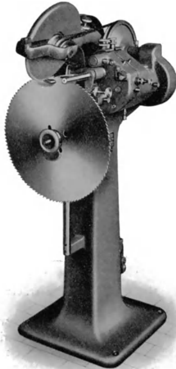
Fig. 148. Die Metallkreissäge-Schärfmaschine der Naxos-Union.
