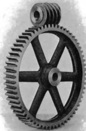
Fig. 350. Schneckenrad mit geraden, im Steigungswinkel der Schnecke schrägstehenden Zähnen.
