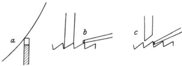
Fig. 150. Die Stellungen des Schleifrades bei dem Abschragen der Zähne.
