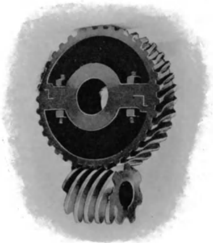
Fig. 345. Helikoidengetriebe von Stolzenberg & Co.
