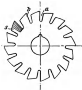
Fig. 15. Der hinterdrehte Fräser.
