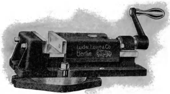
Fig. 169. Der Maschinenschraubstock mit festsitzenden Spannbacken.
