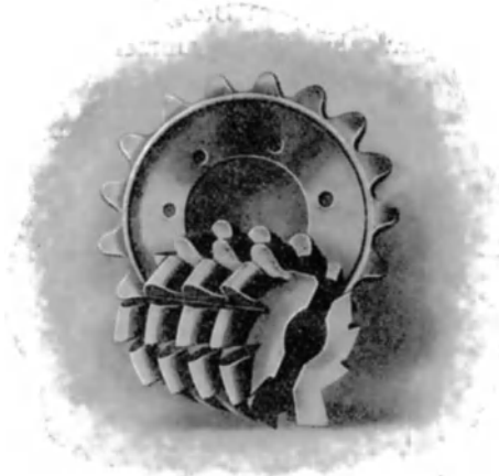
Fig. 315. Kettenzahnrad mit dem dazu gehörigen Abwälzfräser.
