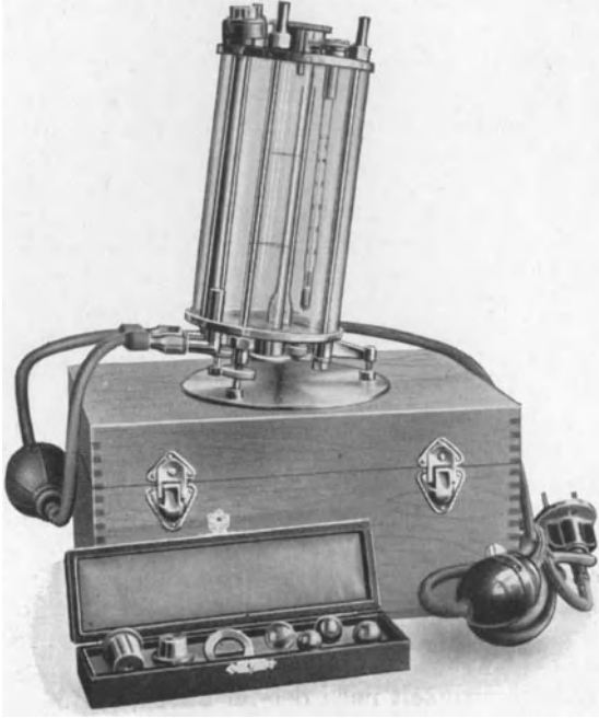
Abb. 4. Universalviscosimeter nach HÖPPLER. (Aus TÄUFEL und SCHOIERER: Z. 1936, 71, 433.)
