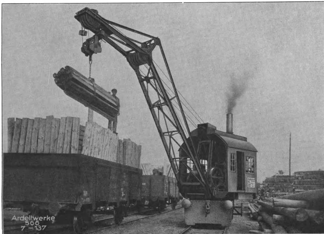
Abb. 27. Normaler Ardelt-Lokomotiv-Dampfkran mit geknicktem Ausleger.
