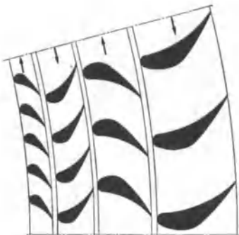
Abb. 177. Schaufelprofile einer Gegenlauf-turbine; günstige strömungstechnische Form (Tropfenform) und hohes Widerstandsmoment.
