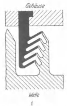
Abb. 72a—f. Dichtungseinzelheiten; Dichtungsringe aus Messing oder Nickellegierung; a radialabdichtend; b und c axialabdichtend; d radial und axial abdichtend; e und f axialdichtend, elastisch (Westinghouse bzw. Metro Vickers) (ältere Ausführung).
