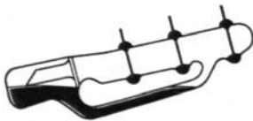
Abb. 34. Quecksilber-Kippkontakt mit verzögerter Kontaktgabe.
