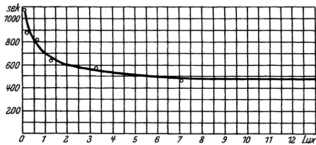
Abb. 22. Abhängigkeit der Zeit für das Auslesen von 25 kg Bergen aus 201,7 kg Kohle von der Beleuchtungsstärke (nach Körfer).
