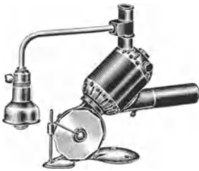
Abb. 15. Elektrische Rollschere zum Zerteilen von Wattevliesen. (Die mitabgebildete Lampe wird selten erforderlich sein!)
