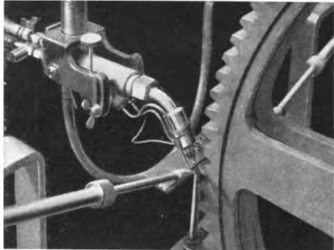
Abb. 19. Härtemaschine für Zahnräder (Griesogen).
