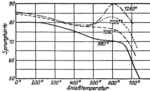
Abb. 34. Härteverlauf von gehärtetem Schnellstahl beim Anlassen.
