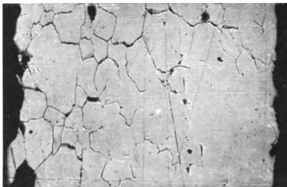
Abb. 30. Interkristalline Korrosion.
