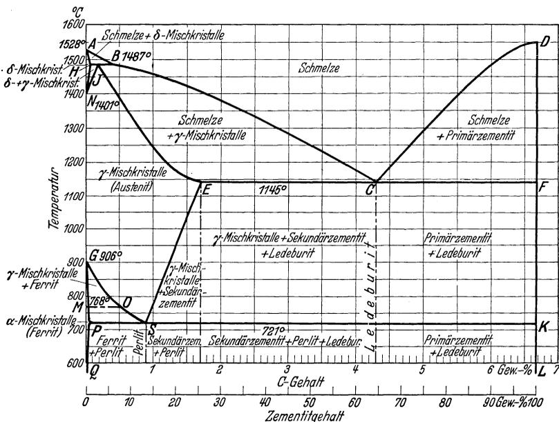
Abb. 10. Eisen-Kohlenstoff-Diagramm.
