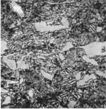
Abb. 9. Kohlenstoffstahl mit etwa 2,2 % C.
