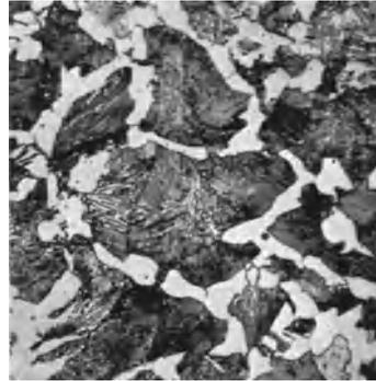
Abb. 7. Kohlenstoffstahl mit etwa 0,5 % C. Ferrit- und Perlitgefüge.
