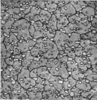
Abb. 32. Richtiges Härtegefüge eines Schnellarbeitsstahles bei etwa 1300° Härtetemperatur.
