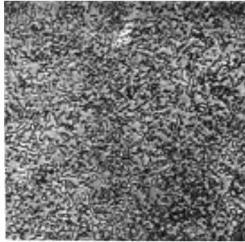
Abb. 13. Weichgeglühter Stahl: kugelige Karbidausbildung.
