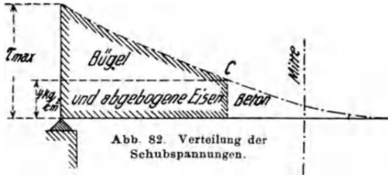
Abb. 82. Verteilung der Schubspannungen.
