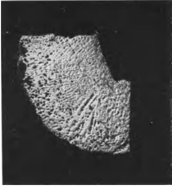
Abb. 70. Hohlraumbildung bei der Diffusion von Bi-Sb. (Nach Masing und Overlach.)
