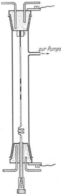
Abb. 120. Apparatur zur Ausführung der elektrolytischen Überführung von Kohlenstoff in festem Stahl.
