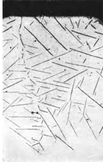
Abb. 111. Verteilung von in Fe diffundiertem Stickstoff in der Nähe einer Korngrenze (Mehl).
