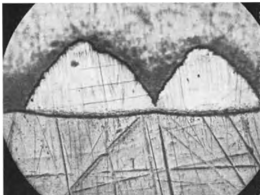
Abb. 61. Warzenbildung zwischen Fe und Zn. (Nach Rigg.)
