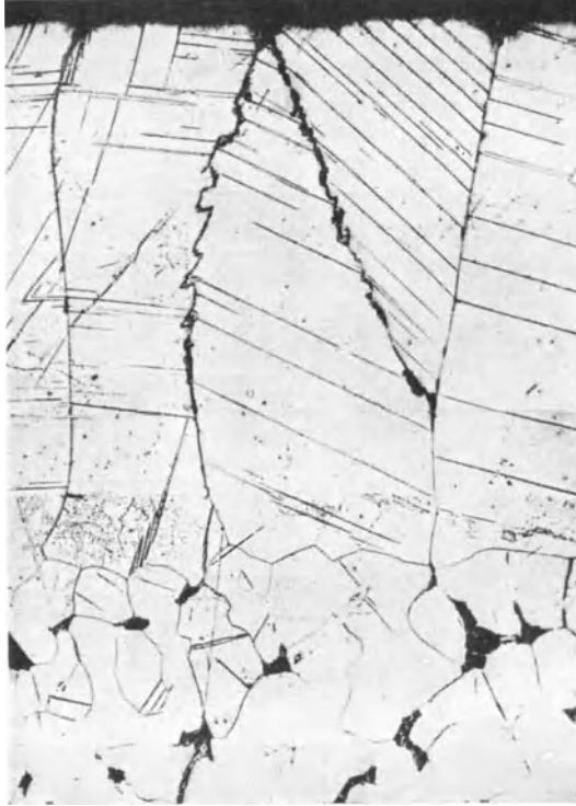
Abb. 54. Säulenkristalle bei der Diffusion von P in Fe (Bramley). 100×.
