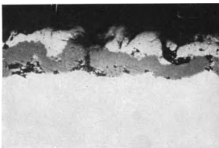
Abb. 84. Zunderschutzschicht auf Tombak (Fröhlich).
