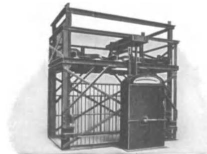
Abb. 260. Großvieh- und Schweinewaage mit automatischer Gewichtseinstellung (Schmidt & Co., Düsseldorf).
