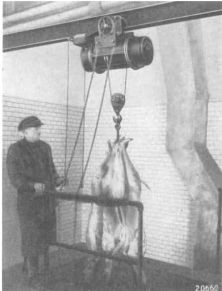
Abb. 223. „Demag“-Elektroflaschenzug.
