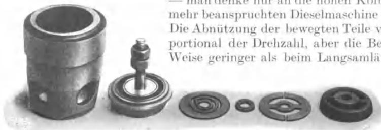
Abb. 347. Teile eines Plattenventils (Sulzer).
