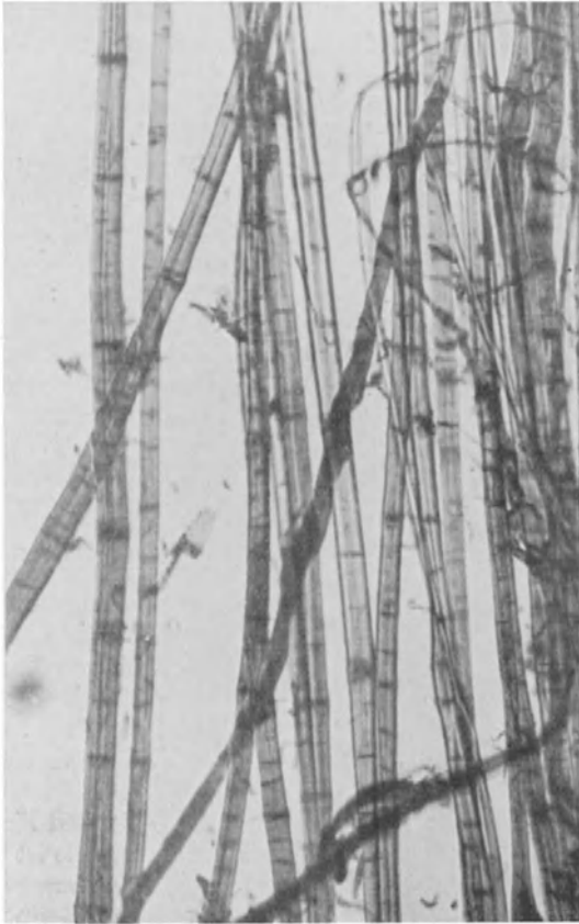
Abb. 58. Faserzellen aus Hechelflachs, in Chlorzinkjod liegend. Verschiebungen und Sprunglinien dunkel hervortretend.
