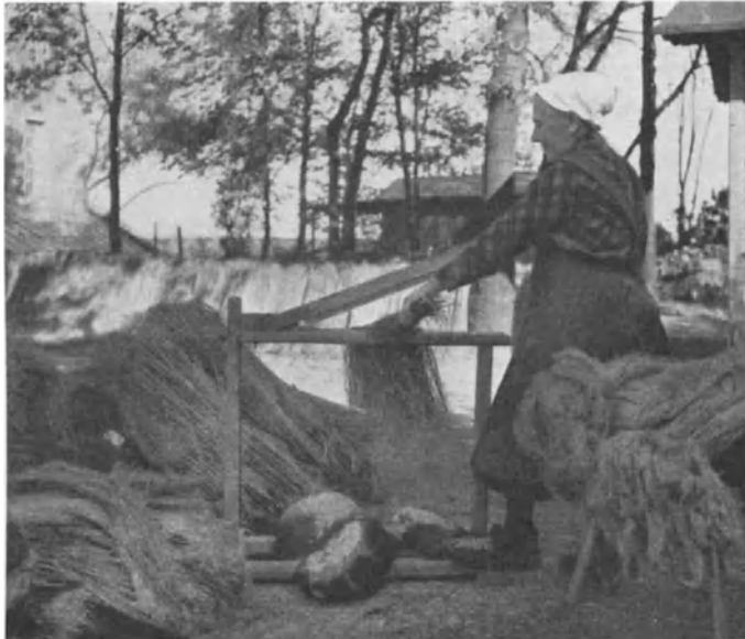
Abb. 25. Bearbeiten des Rstflachses auf der Handbreche.
