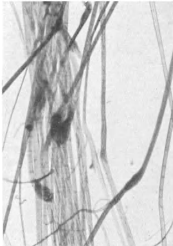
Abb. 60. Ungebleichte Flachsfaser (Hechelflachs) in Chlorzinkjod mit dunklen Quetschstellen.
