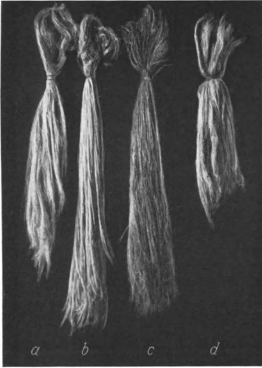
Abb. 43. Flachs nach verschiedenen Verfahren aufbereitet. a überröstet, b richtig geröstet, c unterröstet, d mechanisch aufbereitet.
