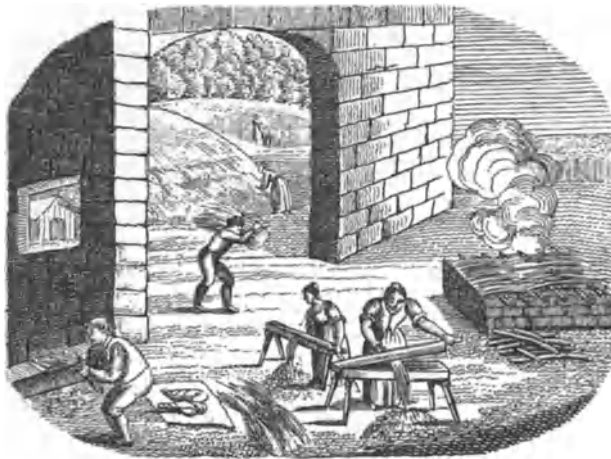
Abb. 3. Eine alte Darstellung der Flachsaufbereitung. (Ernte, Röste, Trocknen, Brechen, Hecheln.)
