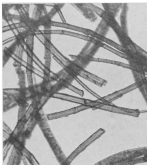
Abb. 63. Flachfasern, über 3000 Jahre alt. Aus einem ägyptischen Mumiengrab. In Wasser liegend, starke Bräunung zeigend. Fasern leicht zerbrechlich, Verschiebungen.
