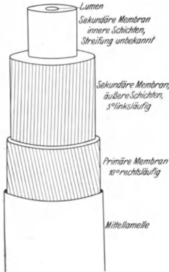
Abb. 50. Schematisches Modell vom Feinbau einer Faserzelle des Leins.
