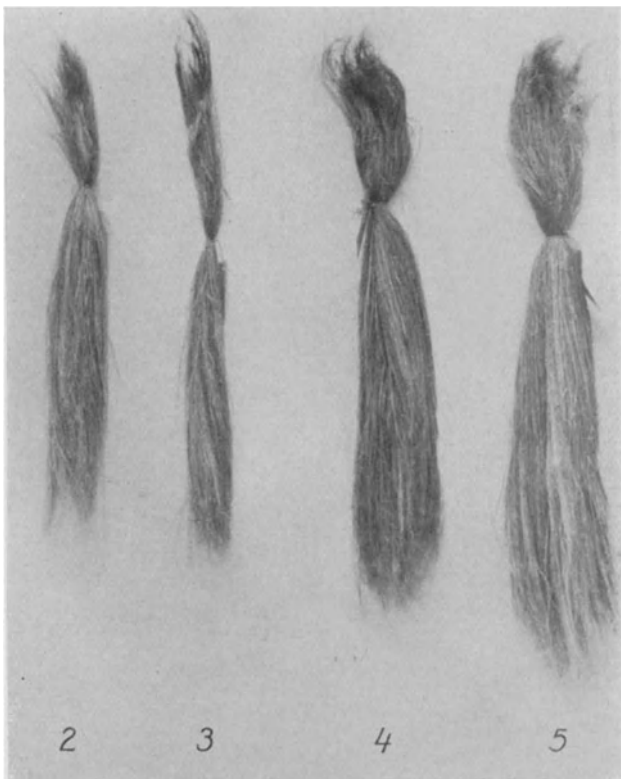
Abb. 13. Schwungflachs aus verschiedenen Röststadien. (Die Zahlen geben die Röstdauer in Tagen an.)
