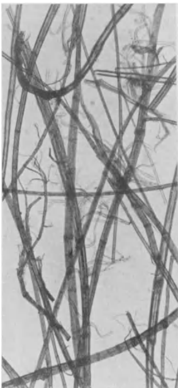
Abb. 62. Fibrilläre Zerschlitung und Bruchstellen der Faserzellen. Aus einem gebrauchten Handtuch.
