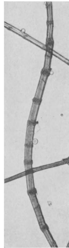
Abb. 59. Faserzelle aus einem gebrauchten Handtuch. Zahlreiche knotige Verschiebungen. In Chlorzinkjod liegend.
