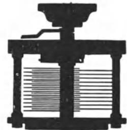
Abb. 270. Drehkondensator. (Aus POUL: Elektrizitätslehre.)
