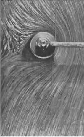
Abb. 161. Strömung um einen rotierenden Zylinder. (Nach PRANDTL.)
