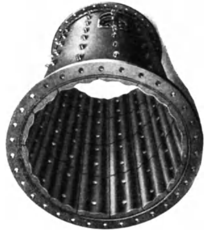
Abb. 1298. Mahltrommel mit gewellter Mahlplatten- panzerung (Krupp-Gruson).
