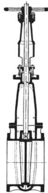
Abb. 1836. Schieber mit außenliegender Spindel (Amag-Hilpert).
