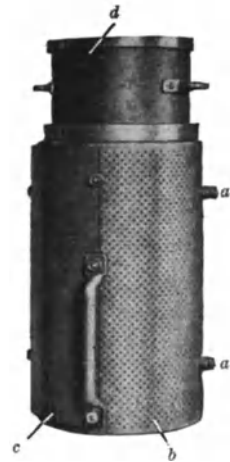
Abb. 1574. Massiver Seiher mit Seiherhut und Mantel. (Nach Ubbelohde , Handbuch.)
