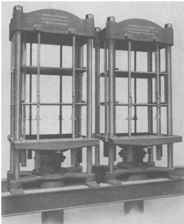
Abb. 1585. Stearinkaltpresse (Harburger Eisen- und Bronzwerke).
