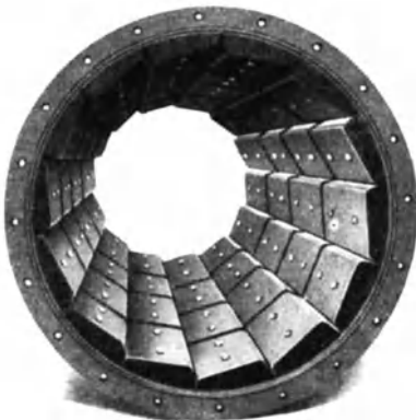
Abb. 1299. Mahltrommel mit stufen- förmig ausgebildeter Mahlplatten- panzerung (Krupp-Gruson).
