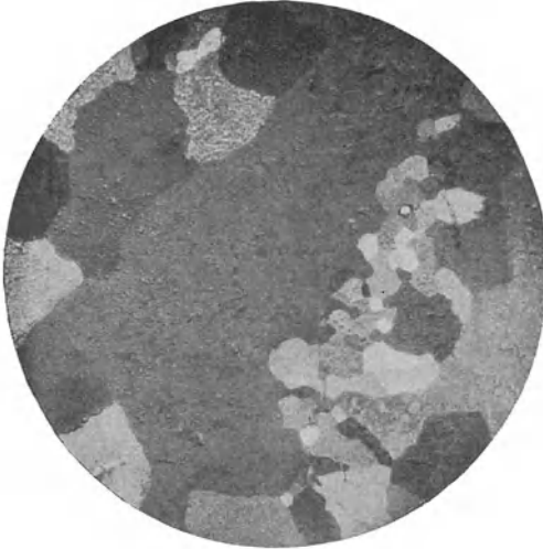
Abb. 1. Mikroskopisches Bild des Gefüges von gegossenem Zinn. Vergr. 6\times . (Aus J. CZOCHRALSKI, Moderne Metallkunde.)
