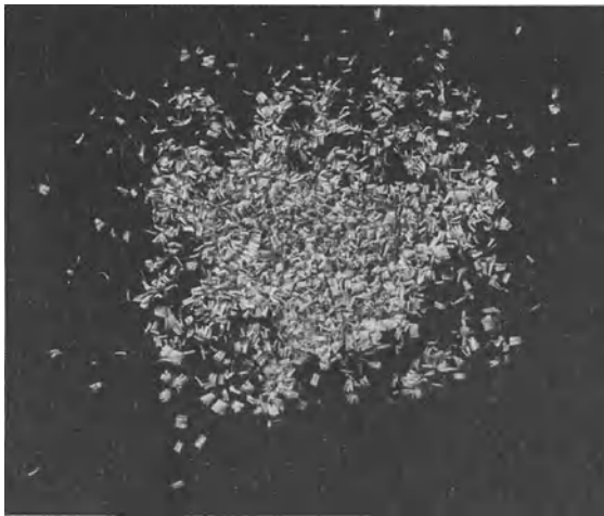
Abb. 50 b. Ein kurzer Span des „Automatenzinks“, hergestellt durch Zusatz von Blei und Wismut zur Legierung Abb. 50 a. (Aus A. BURKHARDT, Technologie der Zinklegierungen.)
