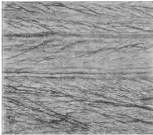
Abb. 108. Struktur einer kaltgereckten Kupfer-Nickel-Legierung. Vergr. 100×. (Nach ADCOCK.)
