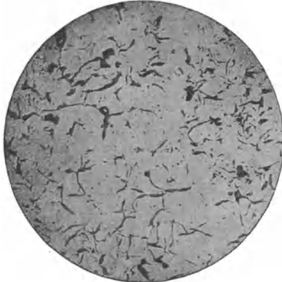
Abb. 60. Graues Gußeisen, ungeätzt. Vergr. 75 ×. (Aus E. PREUSS, Die praktische Nutzenanwendung der Prüfung mit Hilfe des Mikroskopes.)
