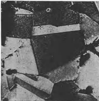
Abb. 66. Reiner Austenit. Stahl mit 1,94% C und 2,24% Mn, von 1050° abgeschreckt. (Aus P. OBERHOFFER, Das technische Eisen.)
