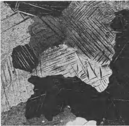
Abb. 95. Zwillinge in einer gebogenen Zink-Lamelle. Vergr. 12×.
