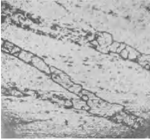
Abb. 109. Gewalzte Kupfer-Nickel-Legierung nach Erhitzung auf 460–480°. Vergr. 650×. (Nach ADCOCK.)
