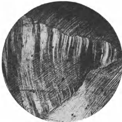
Abb. 97. Gebogene Zwillingsstreifen in verformter Aluminiumbronze. Vergr. 210 \times . (Aus CZOCHRALSKI, Moderne Metallkunde.)
