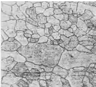
Abb. 113. Kornwachstum in einer Kupfer-Nickel-Legierung nach abgeschlossener Rekristallisation (erhitzt auf 630–640°). Vergr. 350×. (Nach ADCOCK.)
