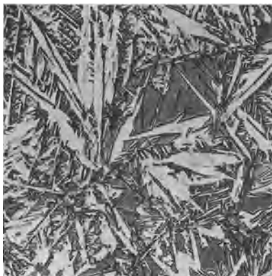
Abb. 68. Weißer tetragonaler Martensit und Restaustenit (dunkel) nach Abschrecken eines Stahles in Wasser von 1050°. Vergr. 500×. (Aus E. HOUDREMENT, Sonderstahlkunde.)
