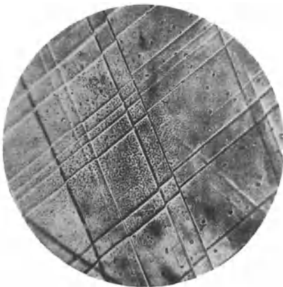
Abb. 83. Gleitlinien auf der Oberfläche eines Bleikristalles als Stufen. Vergr. 1000 \times . (Nach EWING und ROSENHAIN.)
