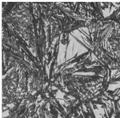
Abb. 69. Kubischer Martensit (dunkel) und Restaustenit (hell) nach Abschrecken eines Stahles von 1050° und Anlassen von 150°. (Aus E. HOUDREMENT, Sonderstahlkunde.)
