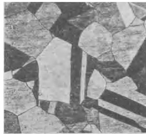
Abb. 114. Kornwachstum mit Zwillingsbildung in einer Kupfer-Nickel-Legierung nach Erhitzung auf 960–980°. Vergr. 100×. (Nach ADCOCK.)
