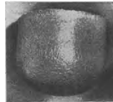
Abb. 120. Feinkörniges Metall, das beim Tiefziehen glatt bleibt.
