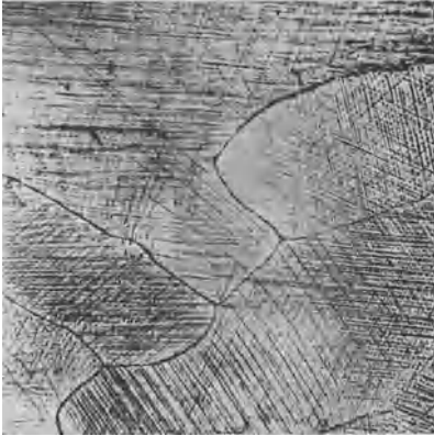
Abb. 82. Gleitlinien auf der Oberfläche von verformtem Blei. Vergr. 100 \times . (Nach EWING und ROSENHAIN.)
