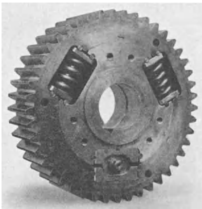
Abb. 63. Gefedertes Zahnrad (BBC).
