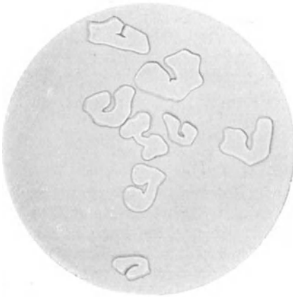
Abb. 41. Querschnitte von Azetatseide. Nach A. Herzog 1) .
