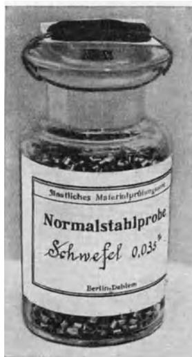
Bild 14 Normal-Stahlproben des Staatlichen Materialprüfungsamts Berlin-Dahlem
