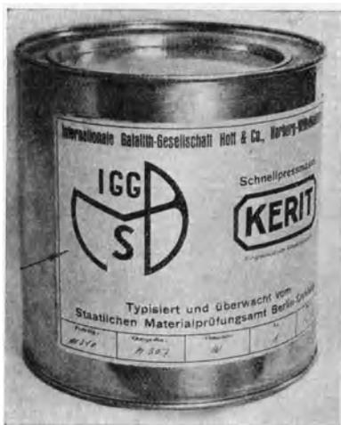
Bild 16 Überwachungszeichen auf der Verpackung typgerechter und überwachter Kunstharz-Preßmassen
