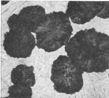
Abb. 17. Troostit (dunkel), eingestreut in Martensit (hell).
