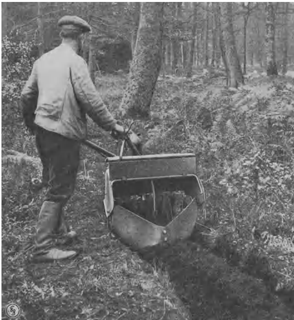
Abb. 176. Siemens-Fräse mit Häufelvorrichtung. (Aus der Sammlung des Iffa, Eberswalde.)
