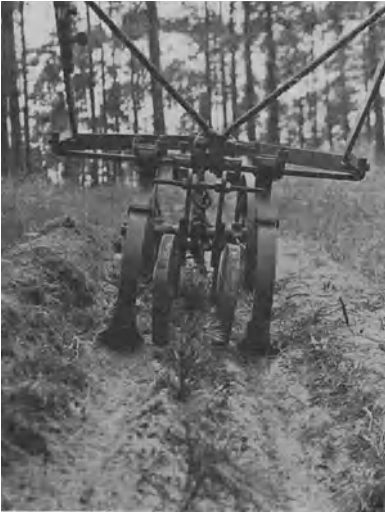
Abb. 212. Maschinenmäßiges Behacken einer Kieferpflanzung mit dem Neumann-Hilfschen Igel mit 2 Hackscharen (rechts und links) und 2 Schutzscheiben (in der Mitte). (Aufn. des Ifa, Eberswalde.)
