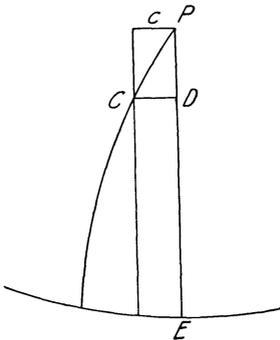
Abb. 6. Orientierungsfehler der Platte. Neigung der Kollimationslinie
