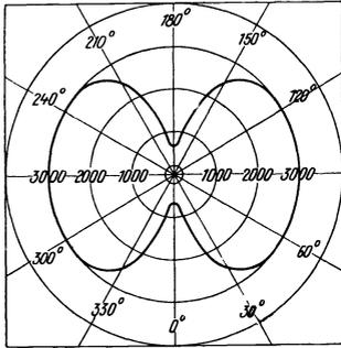
Abb. 29. Lichtverteilung einer röhrenförmigen Projektionslampe für 900 Watt 30 Volt in der Horizontalebene (nach OSRAM G. m. b. H.)
