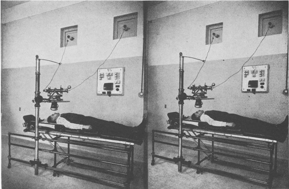
Abb. 128. Apparat für stereoskopische Röntgenaufnahmen
