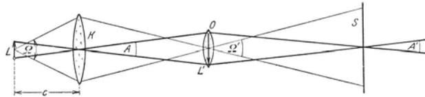
Abb. 4. Lichttechnische Verhältnisse beim einfachsten Projektionssystem
