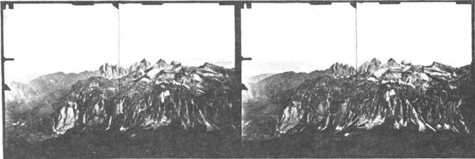
Abb. 77. Stereoaufnahme mit einer Standlinie von 254 m
