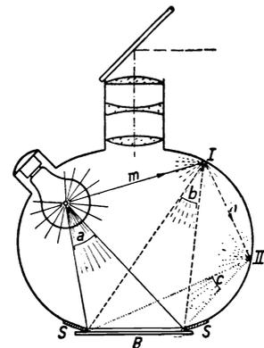
Abb. 22. Kugelepiskop. a = erste Bestrahlung des Bildes B; b = zweite Bestrahlung infolge der ersten diffusen Reflexion (I); c = dritte Bestrahlung infolge der zweiten Reflexion (II). Die Reflexionen wiederholen sich, bis das Licht aufgezehrt ist. Ein Ringspiegel SS verhütet, daß von diesen Stellen Licht ins Objektiv gelangt.
