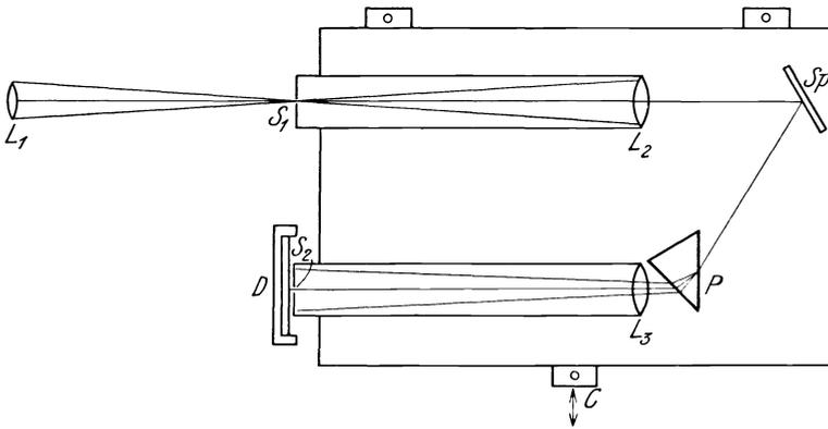
Abb. 47. Schematische Skizze eines Spektroheliographen
