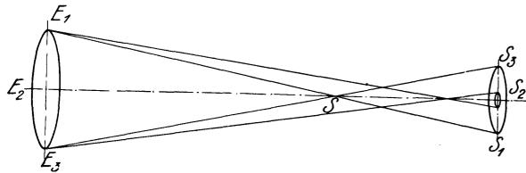
Abb. 17. Schema zur Parallaxendefinition
