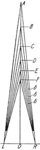
Abb. 15. Verschiedene Tiefenunterschiede bei gleichen Parallaxen
