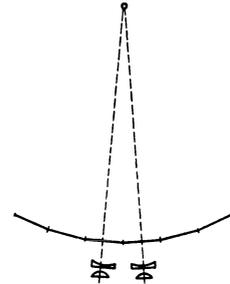
Abb. 112. Betrachtung mehrfacher konzentrischer stereophotographischer Aufnahmen
