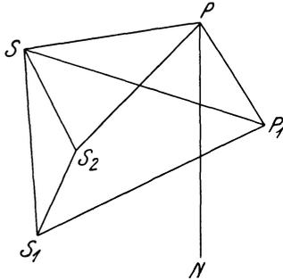
Abb. 4. Orientierungsfehler der Platte. Neigung der Polarachse
