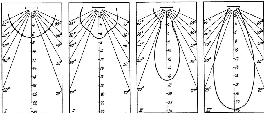
Abb. 46. Reflexionskurven nach K. RETLOW für Gipswand (I), mattes, weißes Papier (II), raue Aluminiumwand (III), glatte Aluminiumwand (IV)
