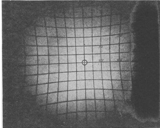
Abb. 39. Verzerrung durch eine einzelne achromatische Linse
