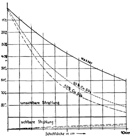
Abb. 33. Absorption der unsichtbaren und sichtbaren Strahlung in reinem Wasser sowie in einer 0,5%igen und einer 1%igen Kupfersulfatlösung
