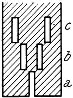
Abb. 37. Einfache Schiebeblende zur Herstellung von Vergleichsspektren
