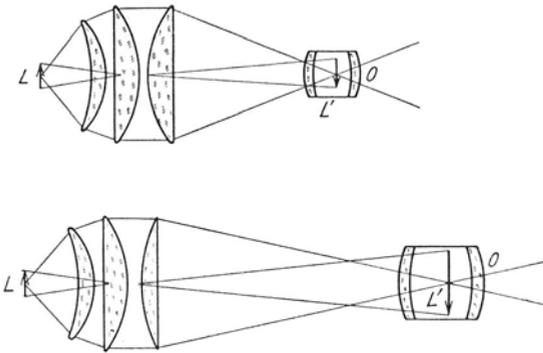
Abb. 11. Die längere Objektivbrennweite im unteren System erfordert, daß hier auch der Kondensator eine Linse von längerer Brennweite erhält
