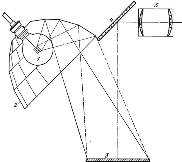
Abb. 20. Glühlampenepiskop mit Polyederspiegel. 1 Glühlampe, 2 Polyederspiegel, 3 Bildfläche, 4 Umkehrspiegel, 5 Objektiv
