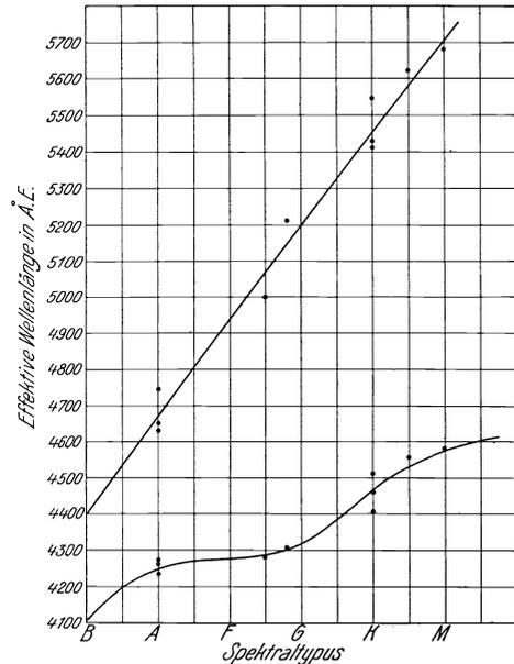
Abb. 26. Zusammenhang zwischen effektiver Wellenlänge und Spektralklasse. Die untere Kurve beruht auf Messungen an gewöhnlichen Platten, die obere Kurve auf Messungen an panchromatischen Platten (bei den Aufnahmen mit letzteren wurden Gelbfilter verwendet)
