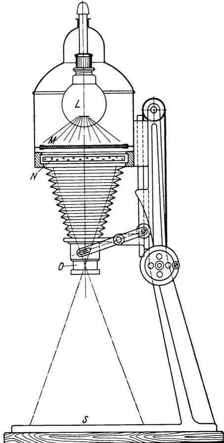
Abb. 52. Vertikaler kondensorloser Vergrößerungsapparat. L Lampe, M Milchglas oder Mattglasscheibe bzw. -scheiben, N Negativbühne, O Objektiv mit selbsttätiger Scharfeinstellung, S Bildfläche.
