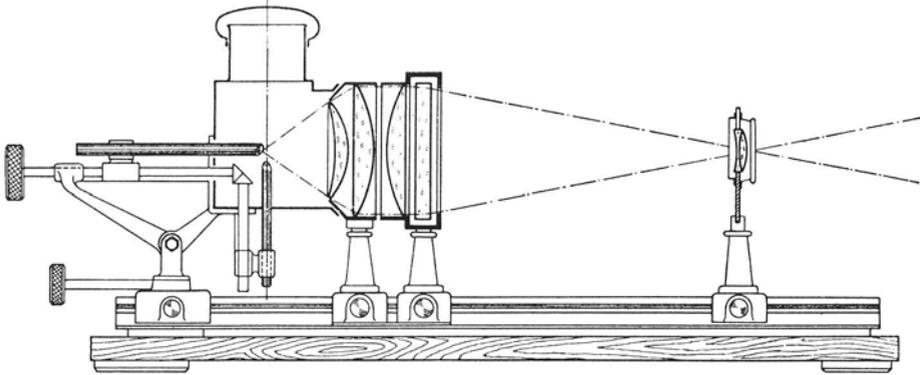
Abb. 37. Diaskopischer Bildwerfer mit Bogenlampe und prismatischer optischer Bank
