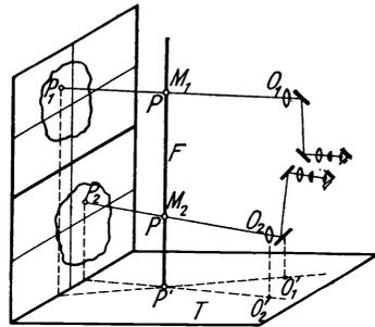
Abb. 132. Röntgenstereodiagraph nach BEYERLEN (schematisch)
