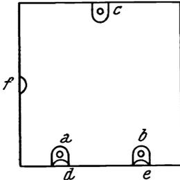
Abb. 8. Korrektions-schrauben zur richtigen Orientierung der Platte
