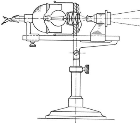
Abb. 41. Kleiner Mikroprojektor mit Niedervoltlämpchen für schwächere Vergrößerungen
