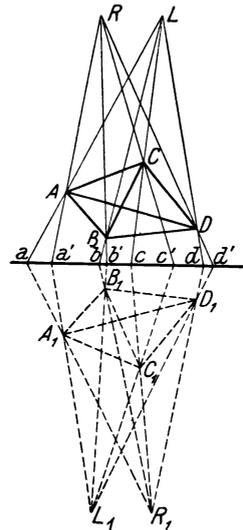
Abb. 133. Röntgenstereobild auf einem fluoreszierenden Schirm
