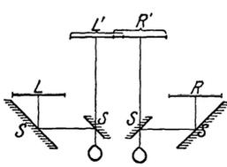
Abb. 30. Telestereoskop nach VON HELMHOLTZ
