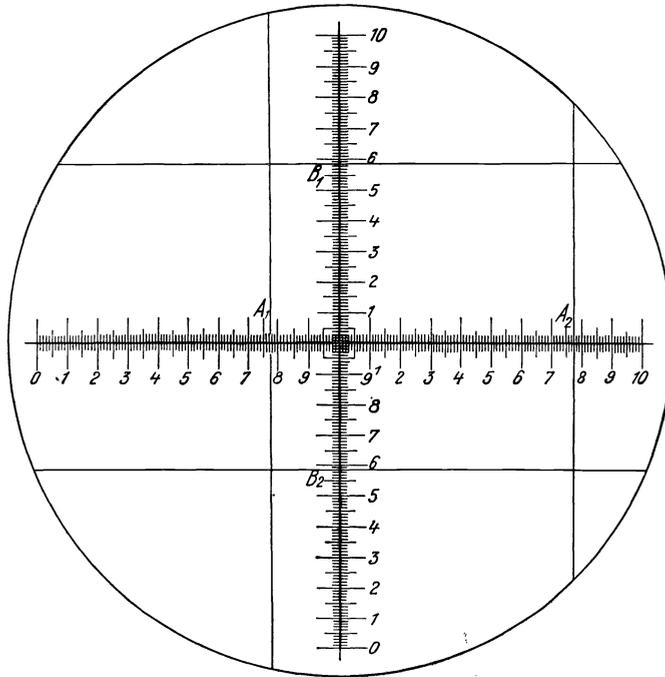
Abb. 11. Glasskala zur Ausmessung einer astrophotographischen Aufnahme
