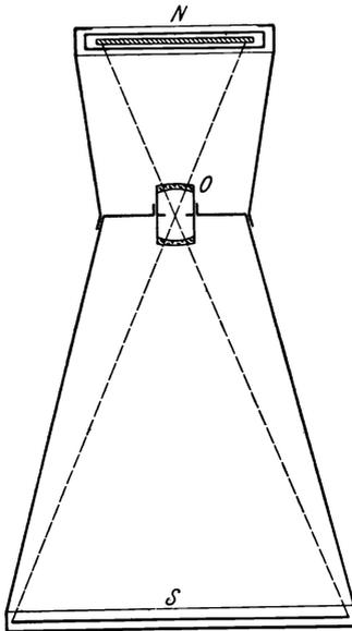
Abb. 53. Fester Tageslicht-Vergrößerungsapparat. N Negativ, O Objektiv, S Bildfläche
