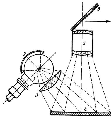
Abb. 19. Glühlampenepiskop mit Linsen Kondensator. 1 Glühlampe, 2 Kugelspiegel, 3 Kondensatorlinse, 4 wiederzugebender Gegenstand, 5 Objektiv, 6 Umkehrspiegel
