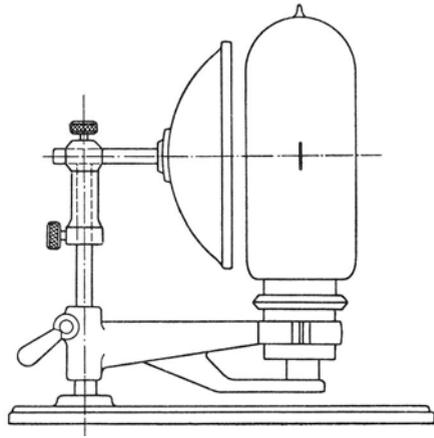
Abb. 31. Röhrenförmige Projektionslampe mit Einstellfuß und kugelförmigem Hilfsspiegel
