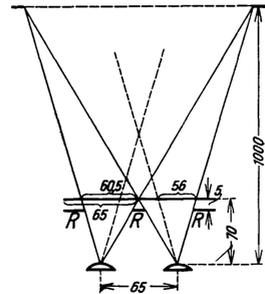
Abb. 62. Scheinrahmen im Stereoskop (schematisch)
