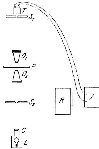
Abb. 24. Schema des thermoelektrischen Mikrophotometers von MOLL
