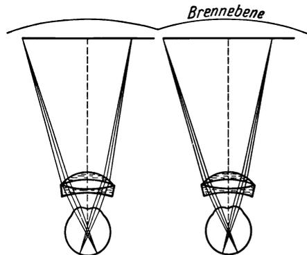
Abb. 40. Verantstereoskop nach M. von ROHR (schematisch)
