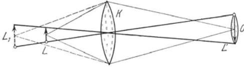
Abb. 7. Projektionssystem mit großer und kleiner Lichtquelle
