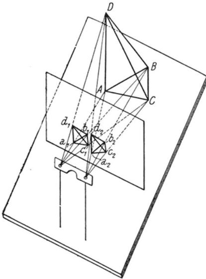
Abb. 22. Zeichnung eines Stereobildes nach einem Modell
