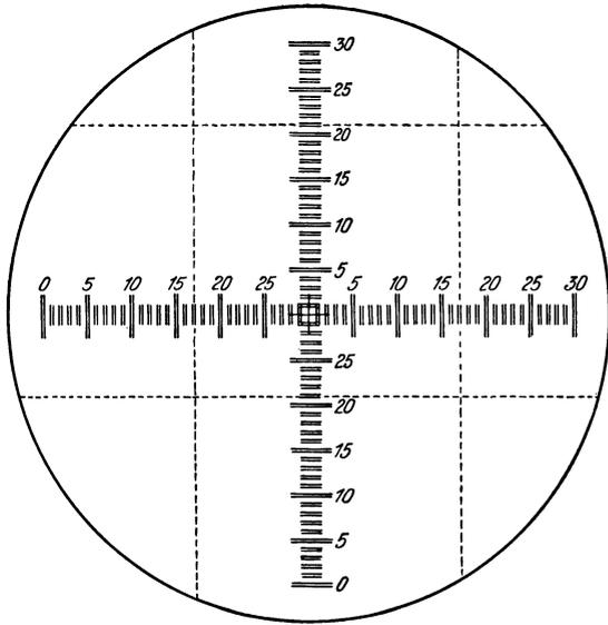
Abb. 13. Zur Ausmessung einer astrophotographischen Aufnahme mit Hilfe einer Glasskala mit doppelten Teilstrichen
