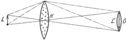
Abb. 3. Einfachstes Projektionssystem (Grundsystem = Projektionsvorrichtung mit eingliedrigem Beleuchtungssystem)
