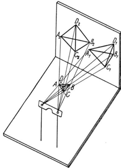
Abb. 25. Stereoskopische Schattenprojektion eines Körpers
