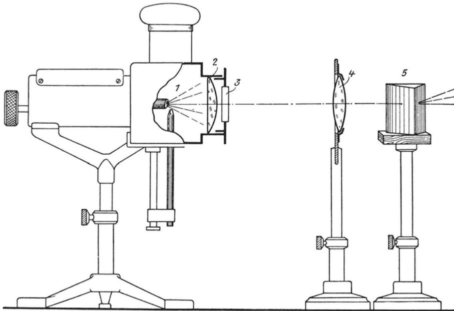
Abb. 42. Freier Aufbau der Versuchsanordnung (Spektrum-Darstellung) mit einer Experimentierbogenlampe. 1 Lampe, 2 Kondensatorlinse, 3 Spalt, 4 Objektivlinse, 5 Prisma
