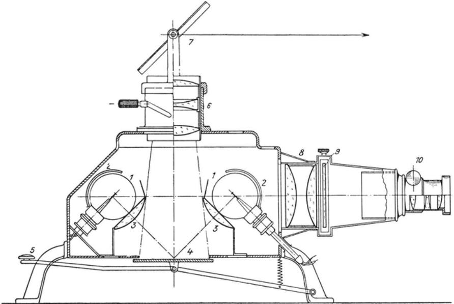
Abb. 43. Glühlampen-Epidiaskop. 1 Lampen, 2 kugelförmige Hilfsspiegel, 3 Kondensorlinsen, 4 Auflagefläche für die zu projizierenden Gegenstände, 5 Hebel zum Niederdrücken der Auflagefläche, 6 Episkop-Objektiv, 7 Umkehrspiegel, 8 Kondensor für die Glasbilder-Projektion, 9 Bildbühne, 10 Diaobjektiv
