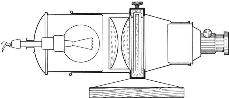
Abb. 35. Diaskopischer Bildwerfer mit eingebauter Lampe von waagrechtcr Lage
