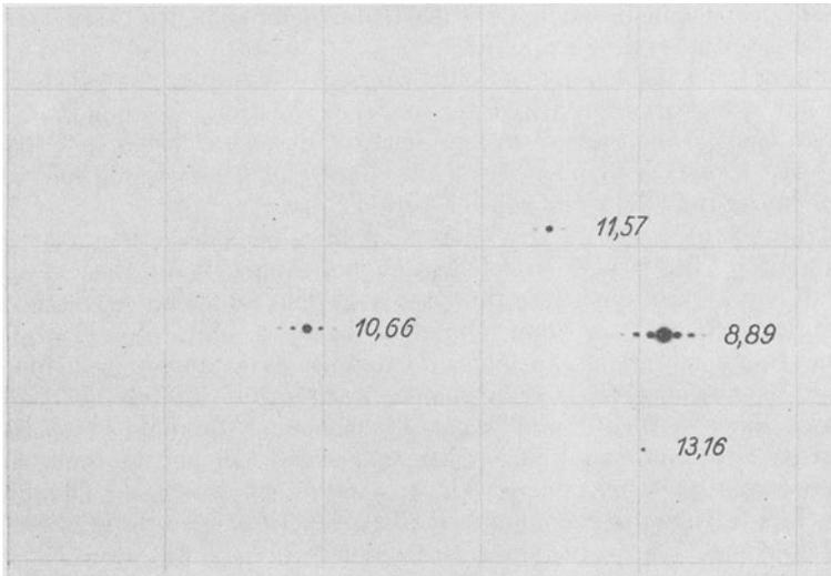
Abb. 21. Zur Anwendung des Objektivgitters in der Astrophotometrie. Die Zahlen geben die angenommenen Größenklassen der Sterne an. Man vergleiche die Hauptbilder der Sterne  $11^m,57$  und  $13^m,16$  mit den Bildern erster Ordnung der Sterne  $8^m,89$  und  $10^m,66$ . Die Gitterkonstante (Größenklassenintervall zwischen Haupt- und Nebenbild) beträgt  $2^m,66$
