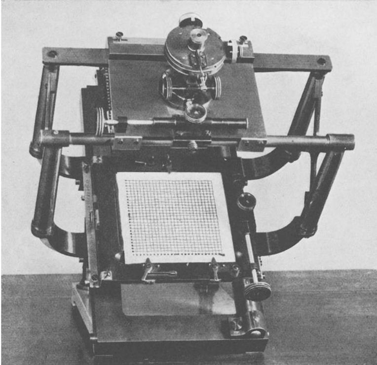
Abb. 12. Apparat mit Meßmikrometer zur genauen Ausmessung astrophotographischer Aufnahmen
