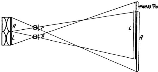
Abb. 97. Stereoprojektion eines Stereobildes mit Hilfe von Farbfiltern
