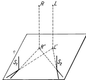
Abb. 129. Bestimmung der Projektion der Perspektivitätszentren bei Röntgenaufnahmen
