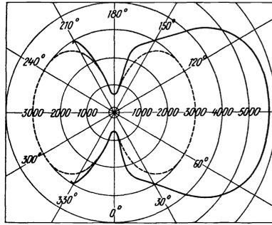
Abb. 30. Lichtverteilung einer röhrenförmigen Projektionslampe für 900 Watt 30 Volt mit kugelförmigem Hilfsspiegel (nach OSRAM G. m. b. H.). Die punktierte Kurve zeigt die Lichtverteilung der nackten Lampe
