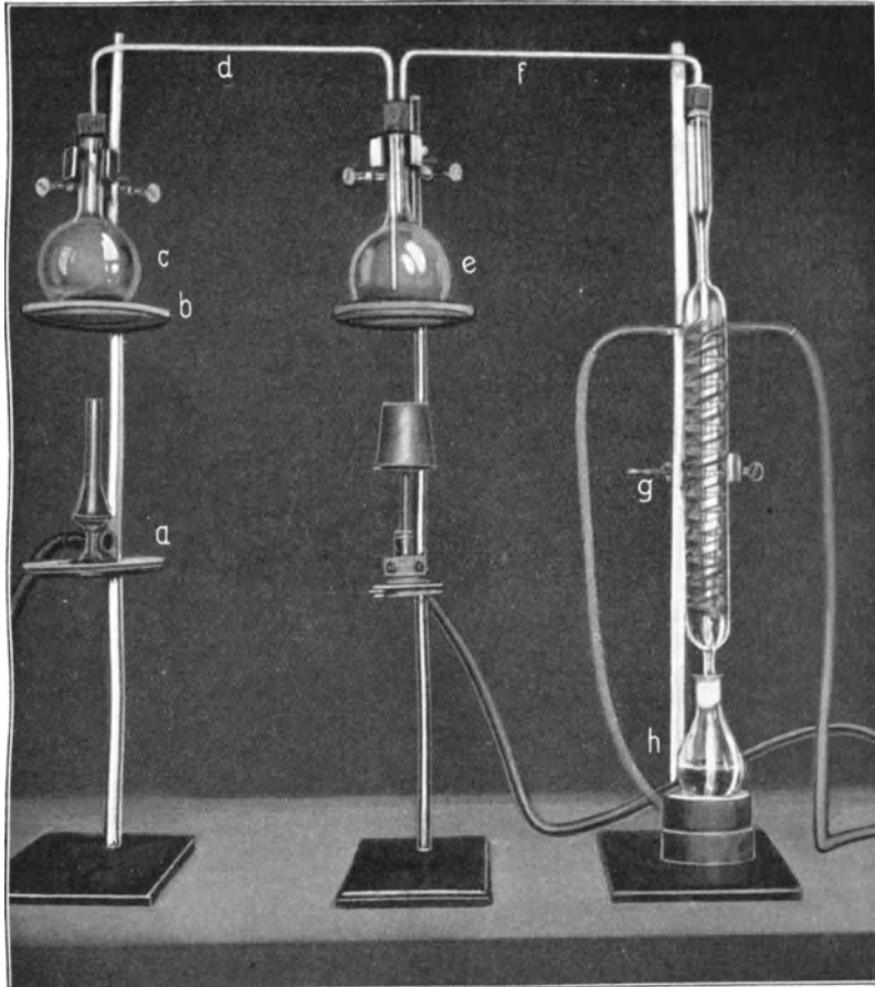
Fig. 5. Destilliereinrichtung zum Nachweis flüchtiger Gifte durch Einleitung von Wasserdampf in den Destillierkolben. Stativ mit Bunsenbrenner a und Kolben c zur Erzeugung des Wasserdampfes; b Drahtnetz; d Verbindungsrohr zwischen Kolben c und Destillierkolben e auf Stativ mit Bunsenbrenner; f Verbindungsrohre zwischen Destillierkolben e und Kühler g; h Vorlagekölbchen auf dem Gestell; die Glasröhrchen d und f sind mittelst durchbohrter Korke in c, e, und g eingeleitet.
