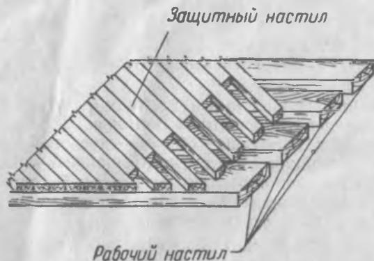
Рис. 110. Двухслойное основание под рулонную кровлю
