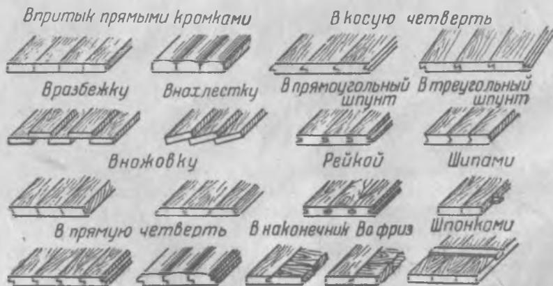
Рис. 64. Сплачивание досок и пластин
