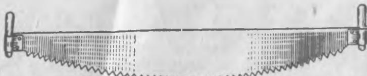
Рис. 22. Поперечная пила
