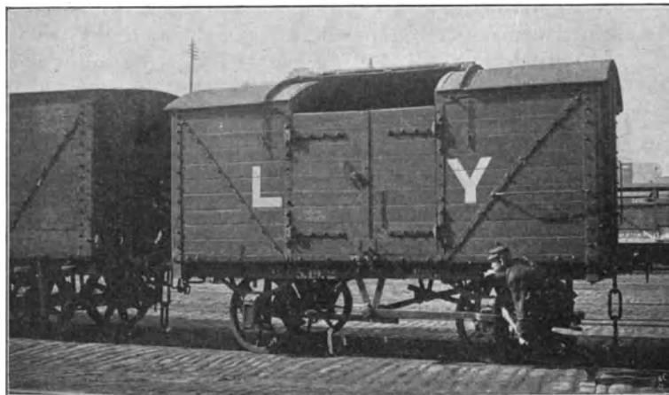
Abb. 40. Vershubbremse an einem englischen Güterwagen. (Nach einer fotogr. Aufnahme von W. Cauer.)
