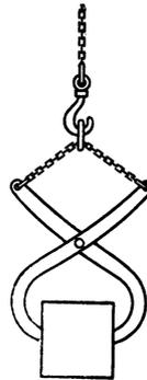
Abb. 40. Gesenkblock in Scherenzange.
