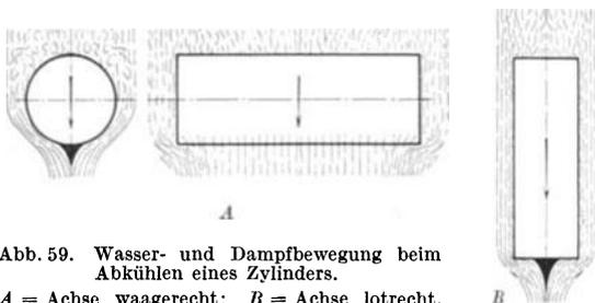
Abb. 59. Wasser- und Dampf bewegung beim Abkühlen eines Zylinders.
