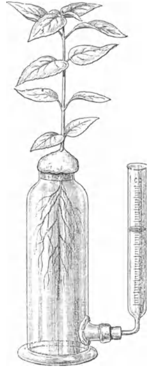
Abb. 166. Apparat (nach Pfeffer) zur Messung der von der Wurzel einer Pflanze aufgenommenen Wassermenge.
