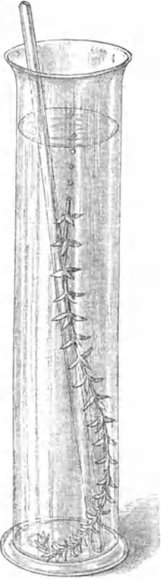
Abb. 174. Apparat (nach Pfeffer) zur Messung der relativen Assimilationsintensität durch Zählung der Sauerstoffblasen.
