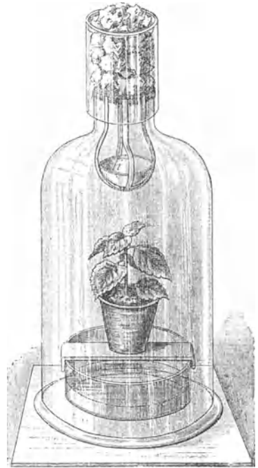
Abb. 176. Apparat (nach Pfeffer) zur Kultur einer Pflanze in kohlendioxydfreier Luft.
