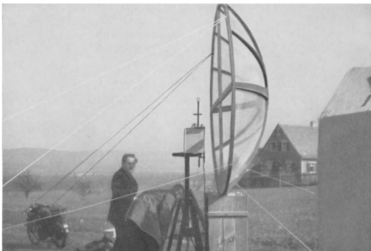
Abb. 62. Ultra-Kurzwellensender mit 14 cm-Wellen nach K. KOHL.
