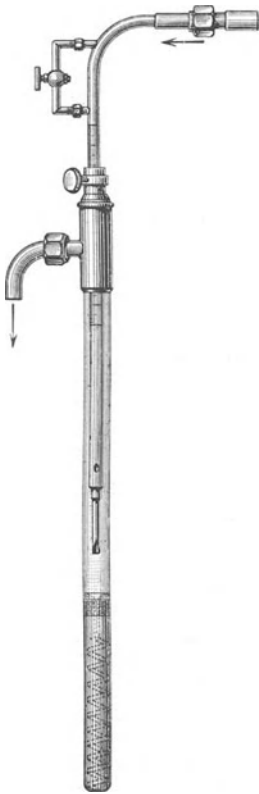
Abb. 31. Thermoregulator. (F. und M. Lautenschläger, Berlin.)
