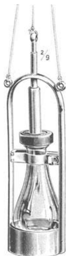
Abb. 50. Apparat zur sterilen Entnahme von Wasser aus der Tiefe. (Nach von Esmarch).
